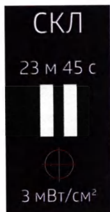
Рисунок 12. Экранная форма режима «Пауза» на блоке излучения. Значок целеуказателя включен
