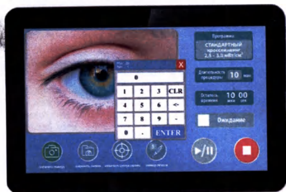
Рисунок 10. Экранная форма на блоке сенсорного управления с окном калькулятора для задания параметров
