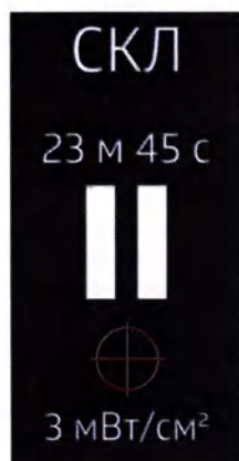
Рисунок 9. Экранная форма режима «Пауза» на блоке излучения. Значок целеуказателя включен
