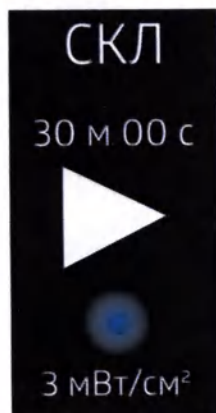
Рисунок 6. Экранная форма режима «Воздействие» на блоке излучения. Символ ● находится в режиме мигания
