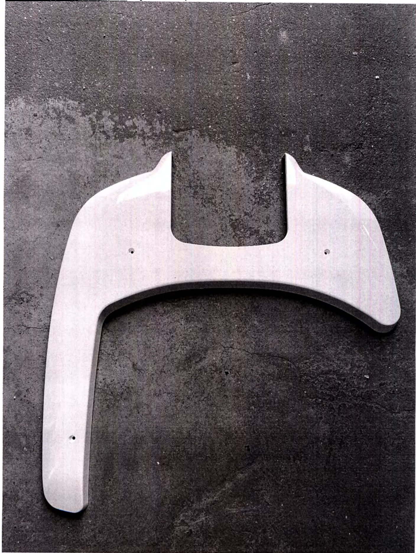
9. Крышка пластиковая плиты - опоры колонны;
