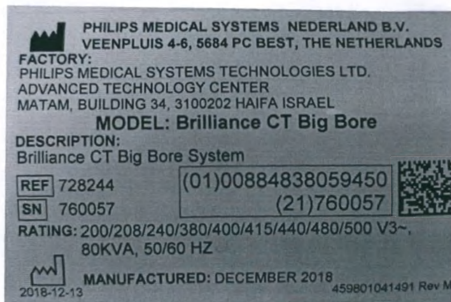
Рисунок 85. Пример оригинальной маркировки томографа компьютерного Big Bore, вариант исполнения Brilliance CT Big Bore.
