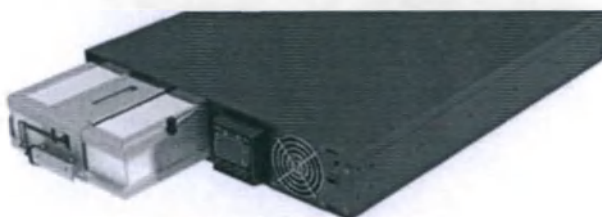
Рисунок 77б. Установка аккумуляторной батареи в ИБП.
