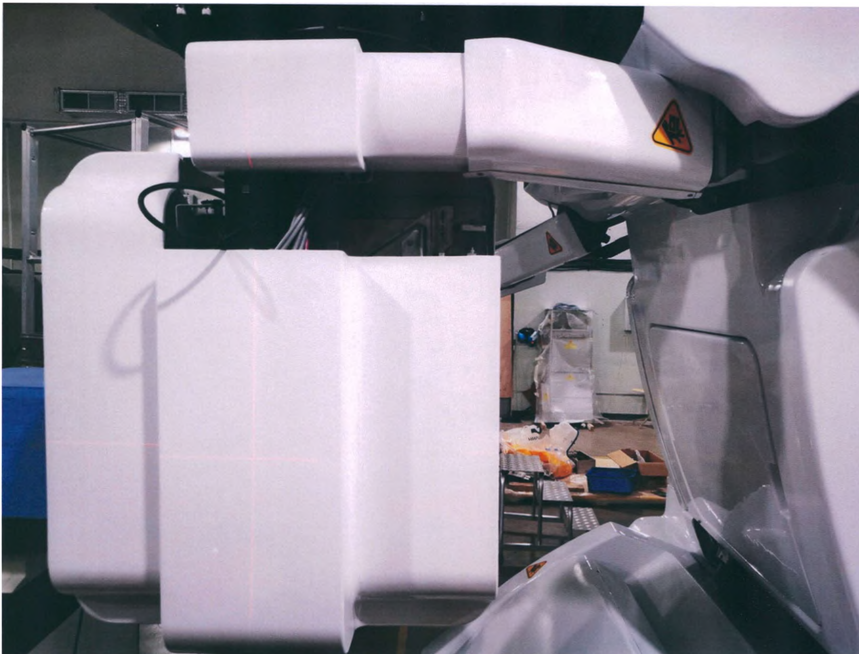
Рисунок 16. Устройство портальной визуализации (детектор рентгеновского излучения).
