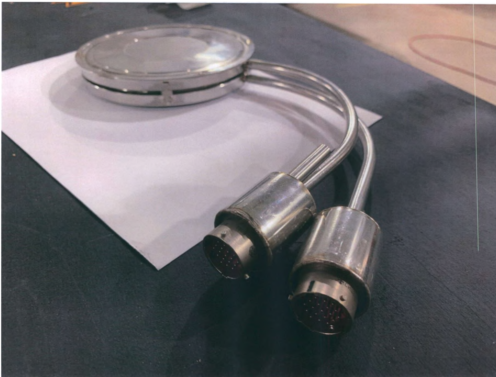
Рисунок 11. Первичная и вторичная система мониторинга дозы (разъемы).
