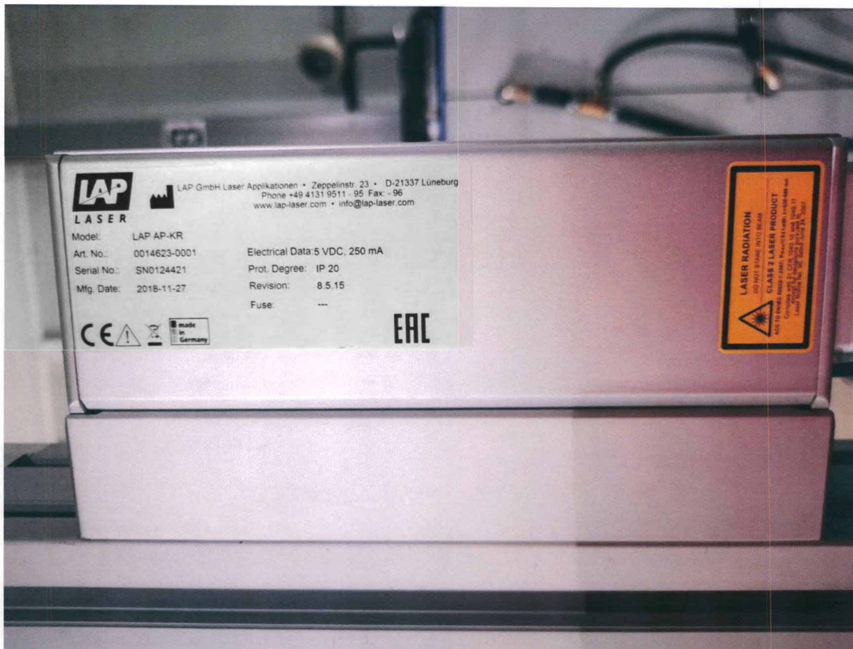
Рисунок 67. Прибор проецирующий перекрестие с ИК-управлением (маркировка).
