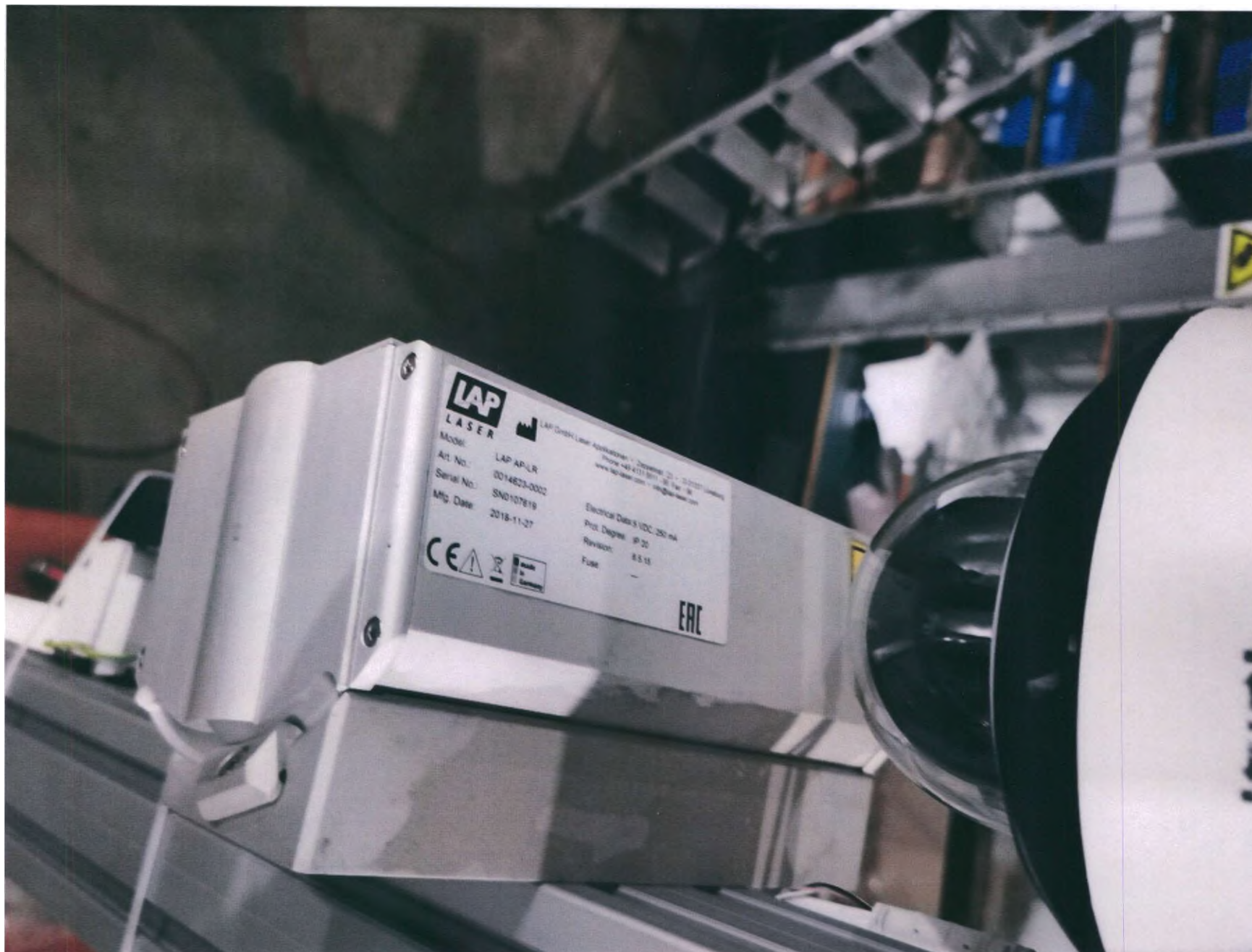
Рисунок 70. Прибор проецирующий линию с ИК-управлением (маркировка).
