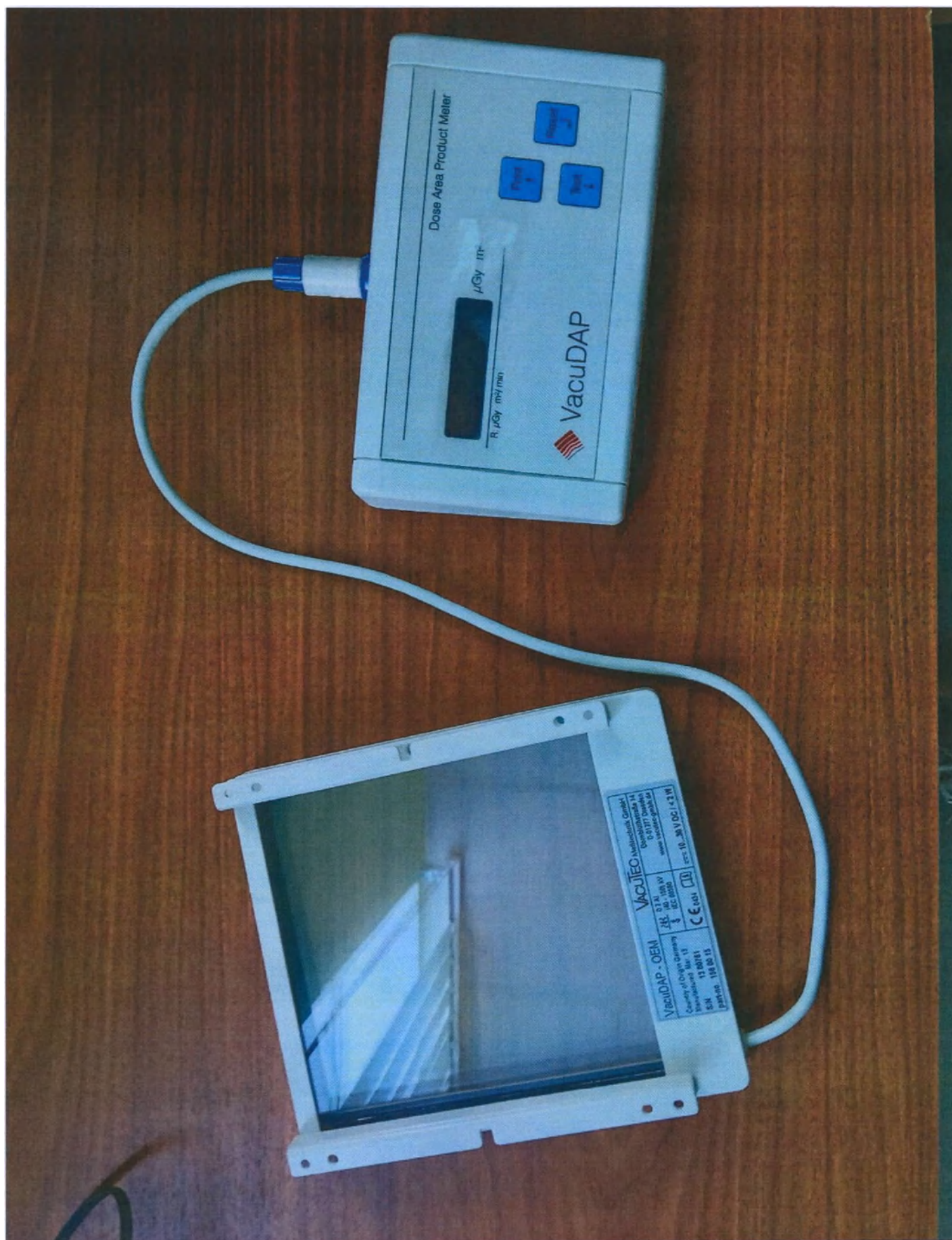
Рис. 26. Дозиметр клинический для контроля радиологических процедур серии VacuDAP System, производства «VacuTec Messtechnik GmbH», Германия.
