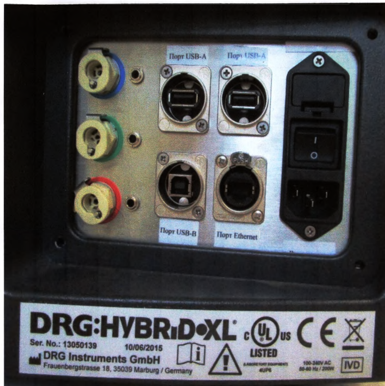
Фотографическое изображение 5. Оригинальная маркировка, выключатель питания и порты базового блока с предустановленным ПО
