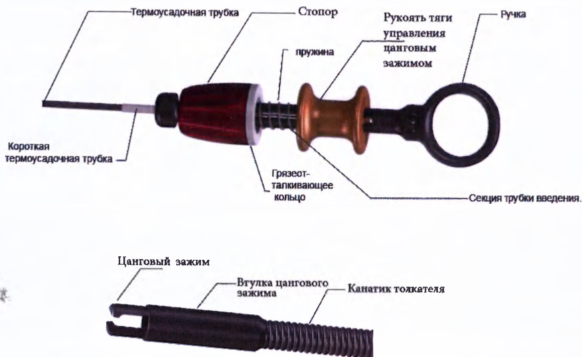
Рис.6. Схематичное изображение толкателя Flex-Pusher II
