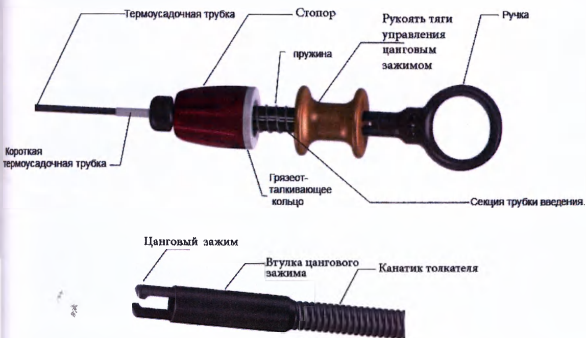
Рис.6. Схематичное изображение толкателя Flex-Pusher II
