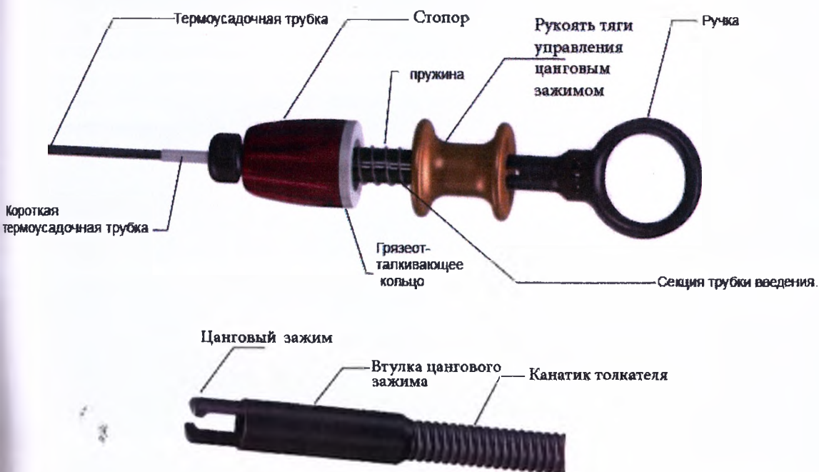
Рис.6. Схематичное изображение толкателя Flex-Pusher II
