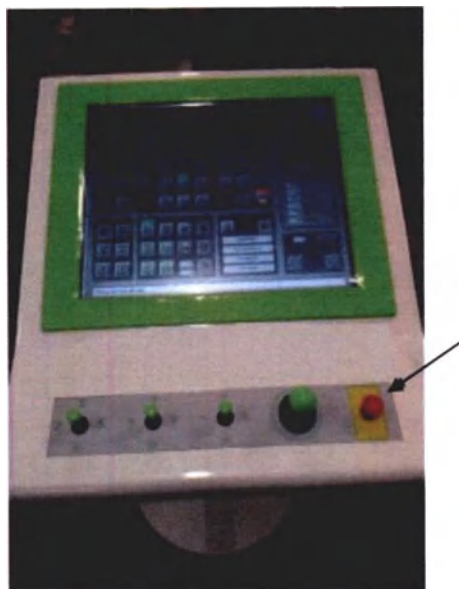
Рисунок 2.1 - Аварийная кнопка главного пульта управления комплексом
