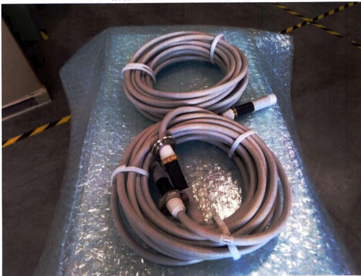
19. Комплект высоковольтных кабелей:
