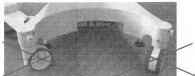
Рисунок 6-21: Выравнивание колес кровати пациента в направлении поворота для лазера SCHWIND AMARIS 500E
