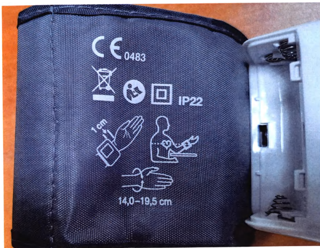
Рисунок 24. Тонومتر автоматический Beurer модели BC 28 (Электронный блок с манжетой и Батарейки AAA)
