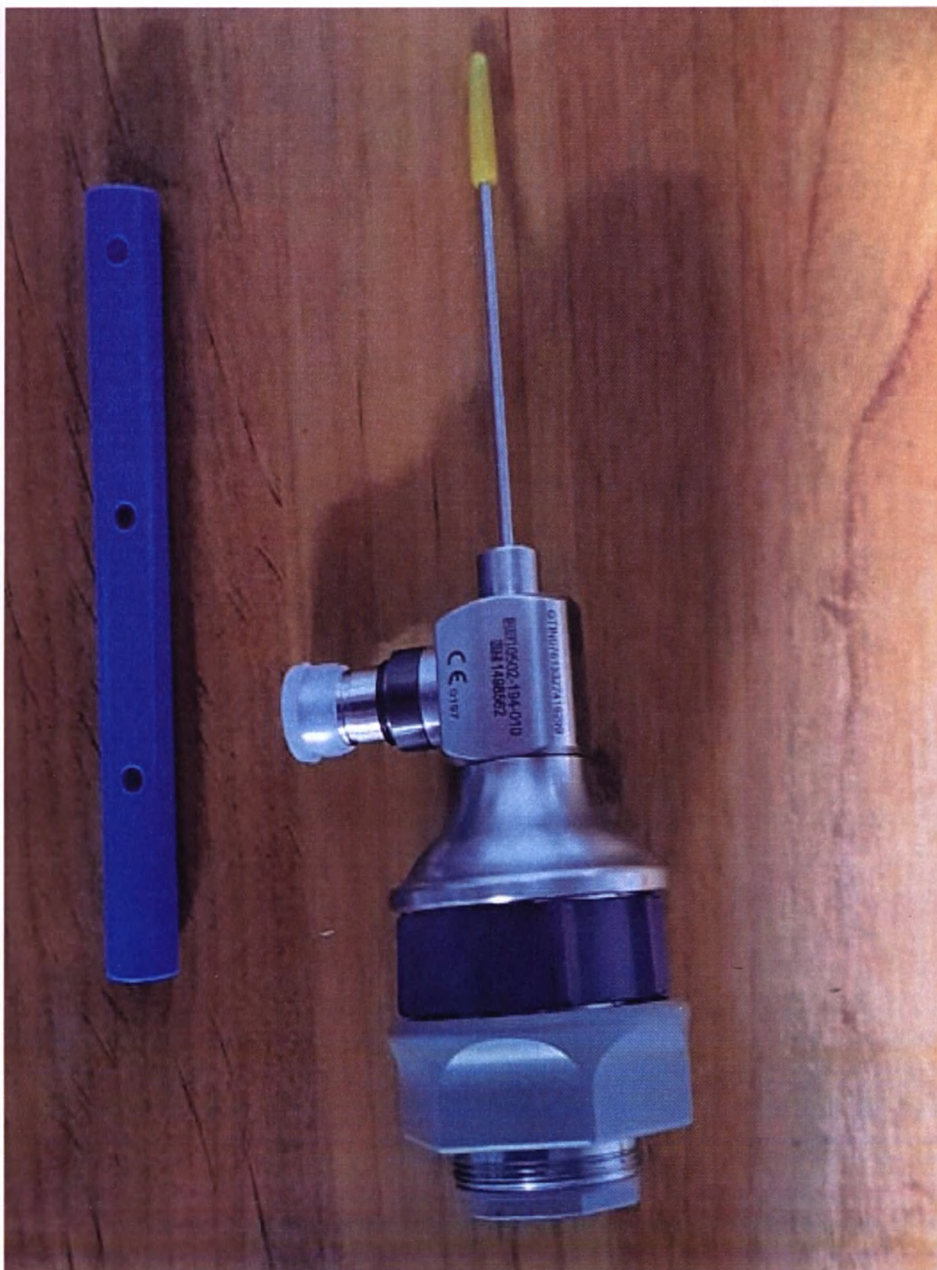
Артроскоп Precision IE 4K с С-образным креплением 1,9 мм x 0°, 58 мм, с J-образным фиксатором
