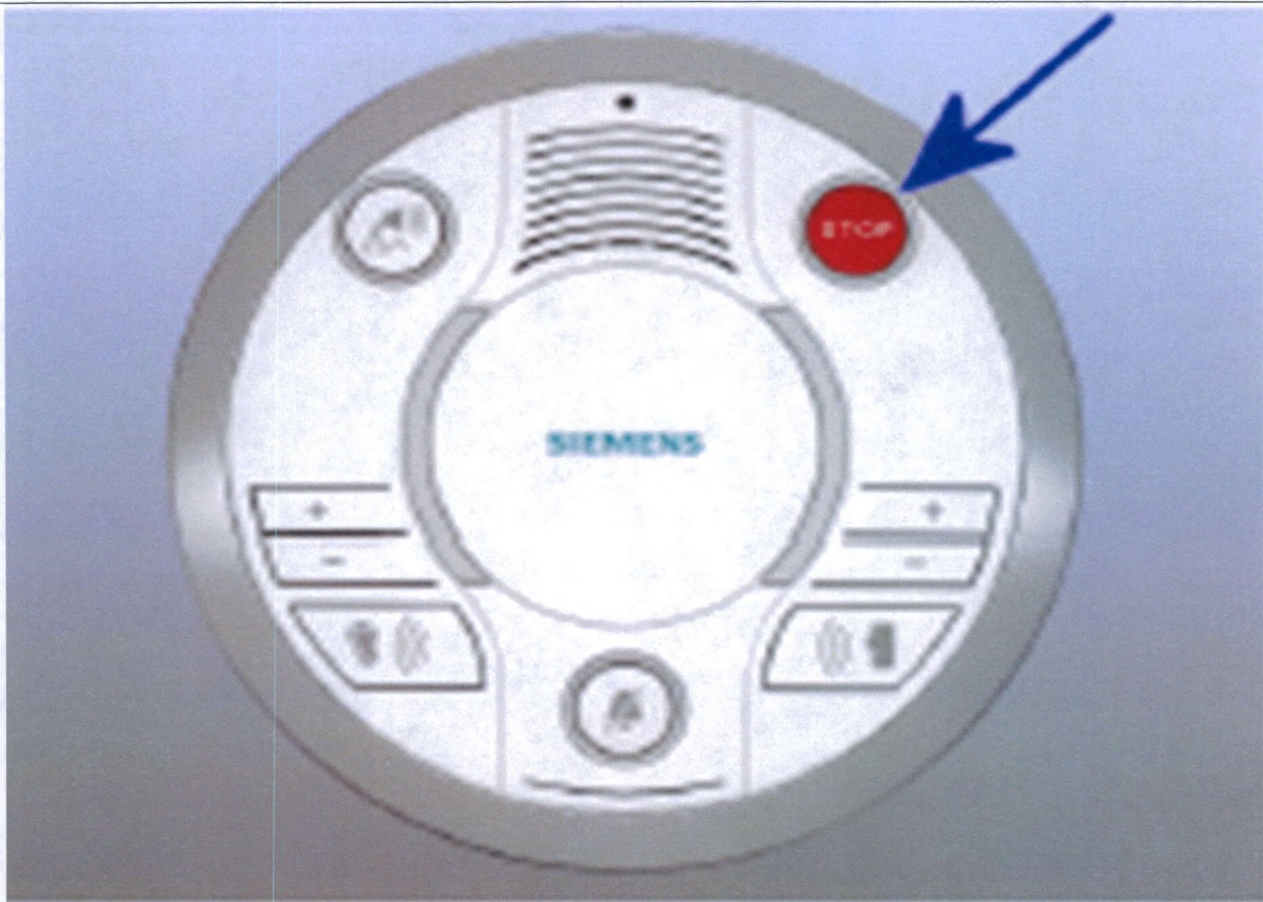
9.3. Выключатели аварийные. Кнопки Table Stop на переговорном устройстве.
