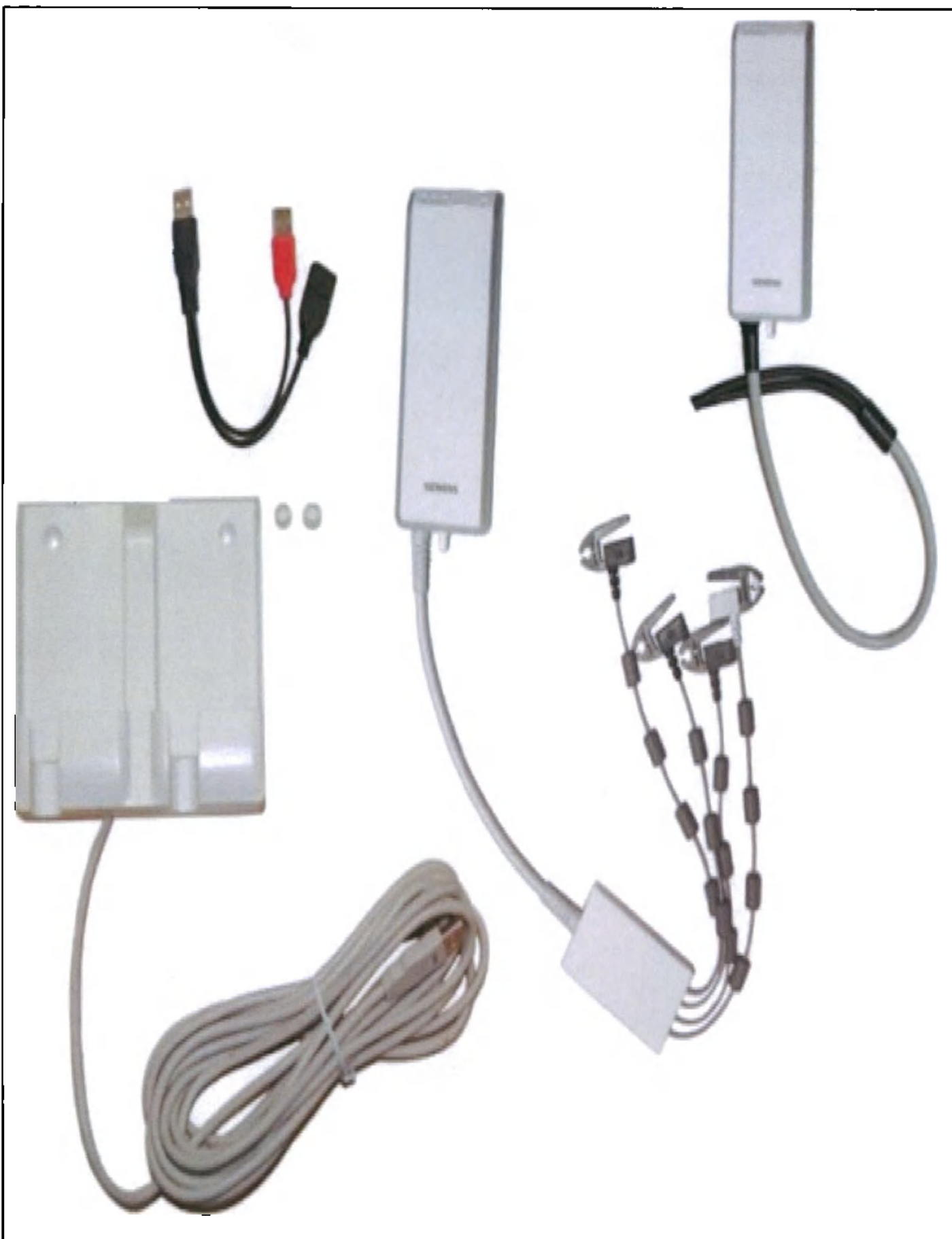
48. Блок для измерения физиологических параметров: датчик ЭКГ; датчик дыхания; датчик пульса; вход внешнего запуска.
