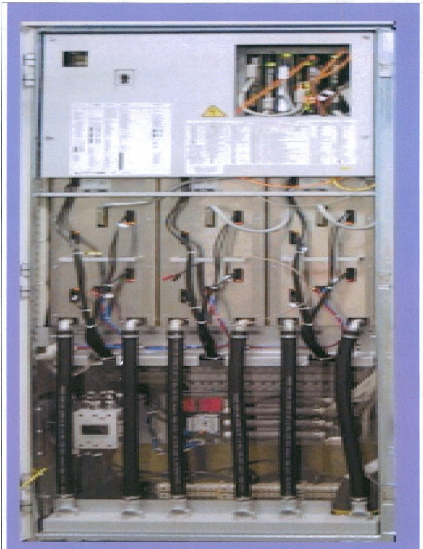
2.3. Система градиентная в составе: катушки градиентные, 3 пары; усилитель градиентный. XJ градиент.
