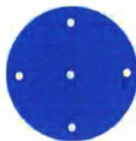
Изображение цилиндра из ПММА для измерения CTDI
