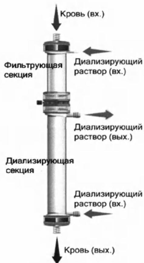
Диализатор PNH – структурная схема
