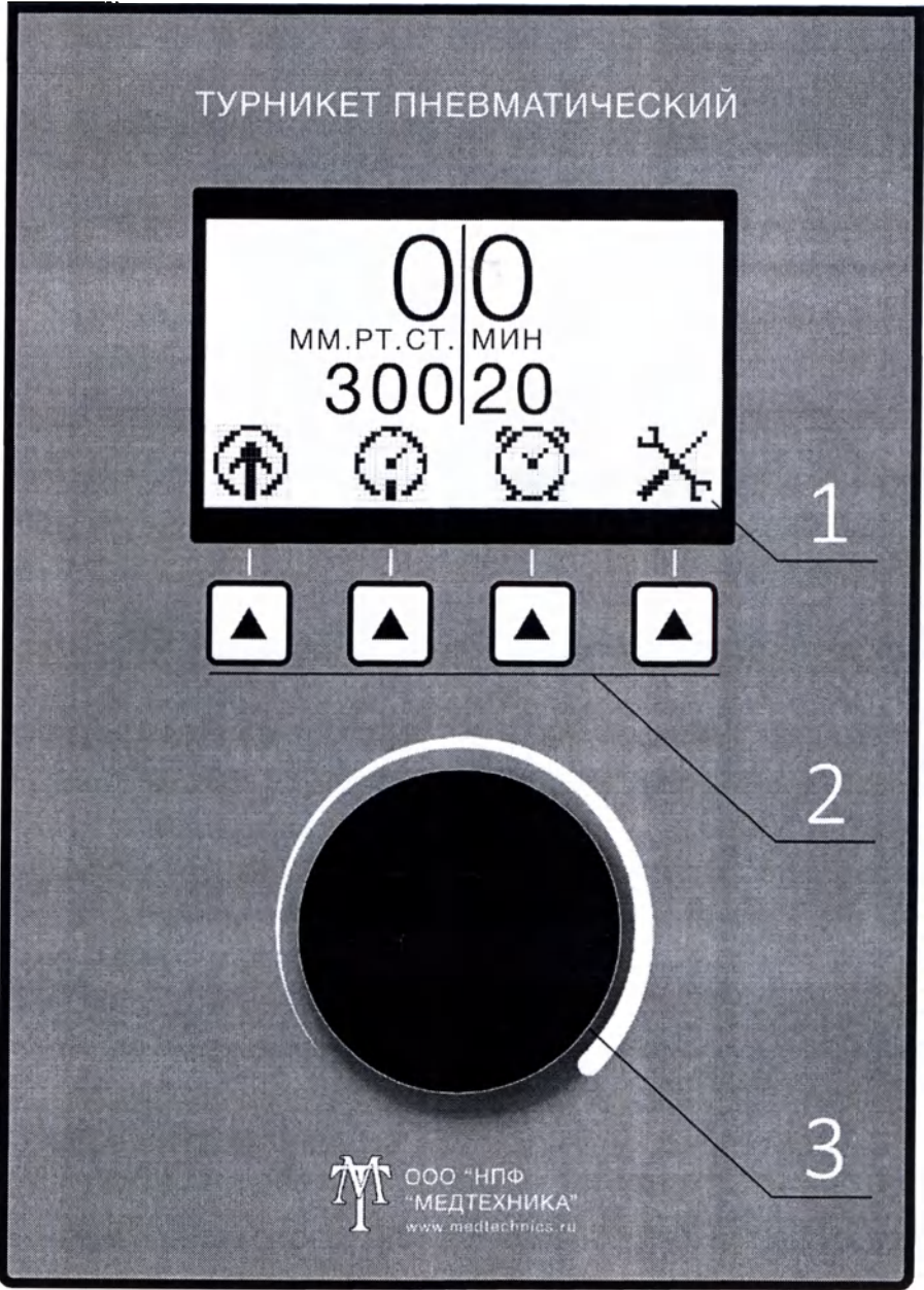
Рисунок 1. Общий вид лицевой панели, где: 1 – жидкокристаллический дисплей с общим видом главного меню, 2 – квадратные кнопки управления, 3 – поворотный переключатель.
