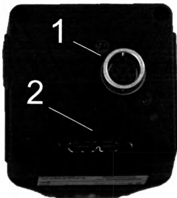
Рисунок 58 — Вид сверху 1 – 8-контактный разъем GPI/O, 2 – разъем USB 3.1
