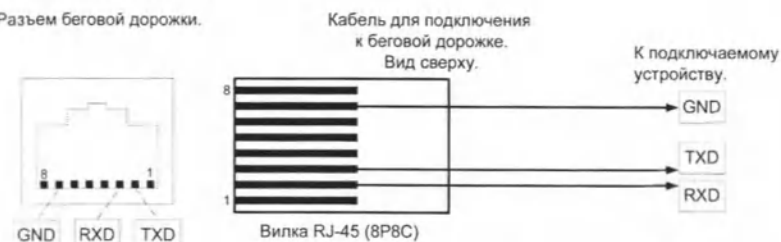
Рисунок 12 – Расположение выводов разъема для подключения внешних вспомогательных устройств или периферии
