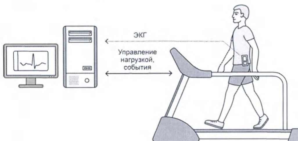
Рис. 1. Функциональная схема комплекса в режиме проведения нагрузочного тестирования
