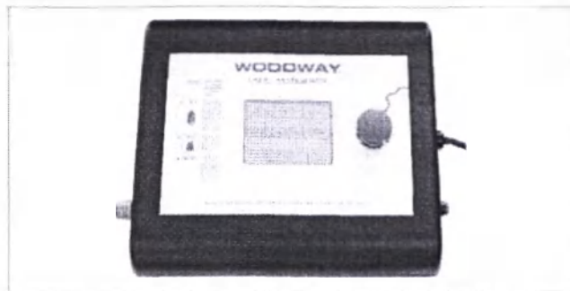
Рис. 16. Внешняя система пользователя WOODWAY (WUS) с выключателем экстренной остановки.
