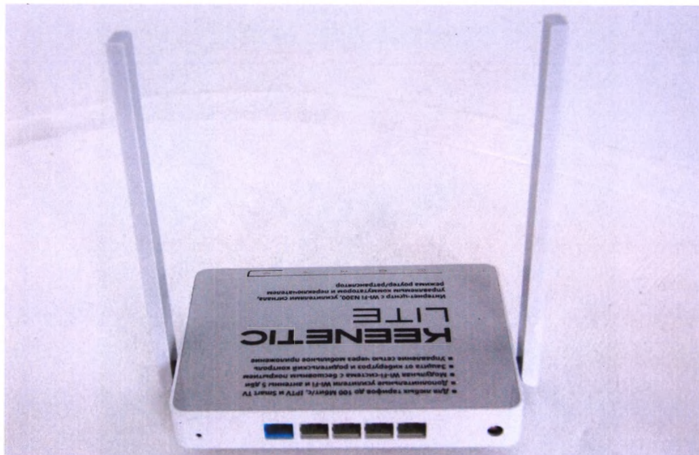
Маршрутизатор, наличие не менее 5 портов, интерфейс LAN (производитель MultiWAN Keenetic Lite (Keenetic-1810))
