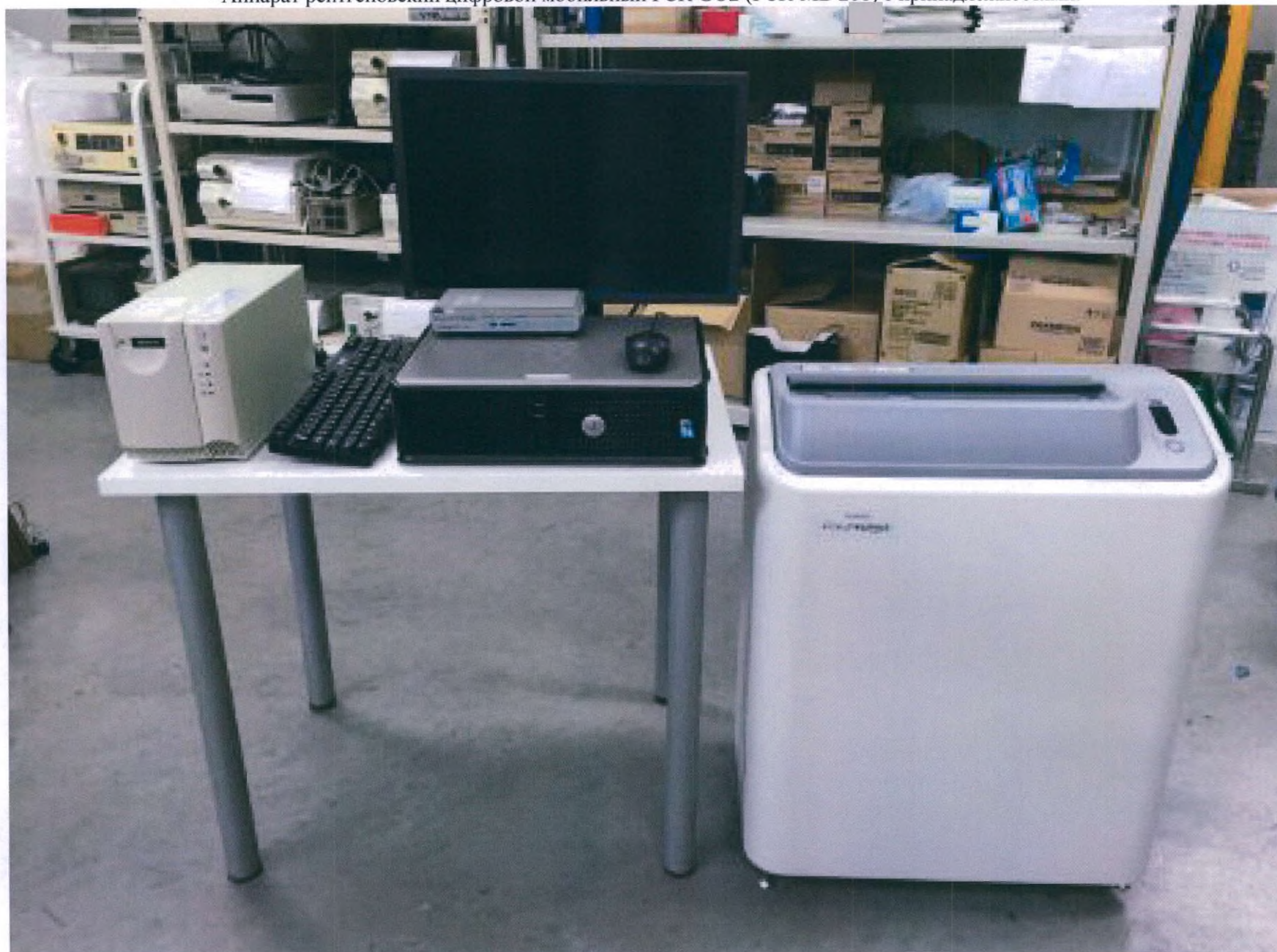
- Аппарат рентгеновский цифровой мобильный FCR GO2 (FCR-MB 201) с принадлежностями:
