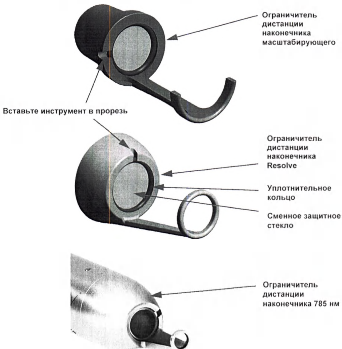
Рис. 15: Замена защитного стекла ограничителя дистанции
