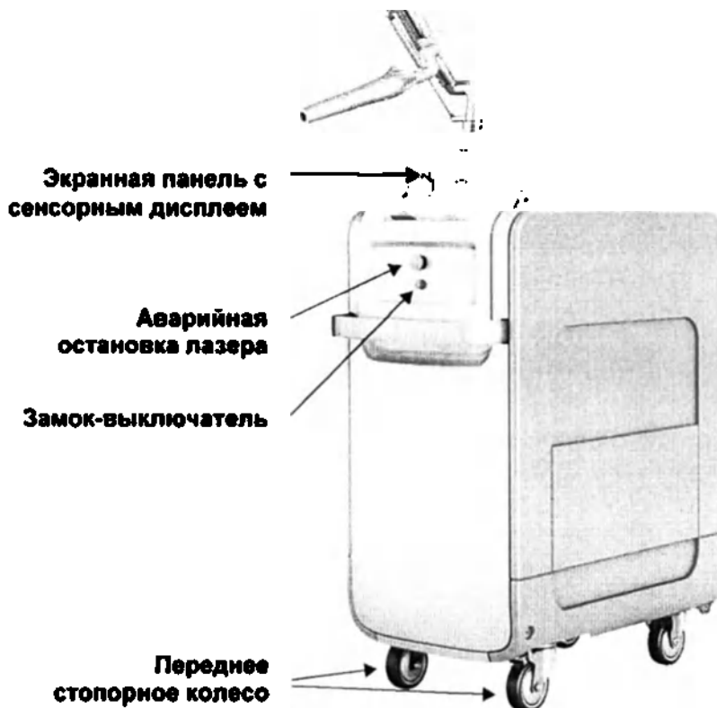
Рис. 2: Лицевая панель лазерной системы
