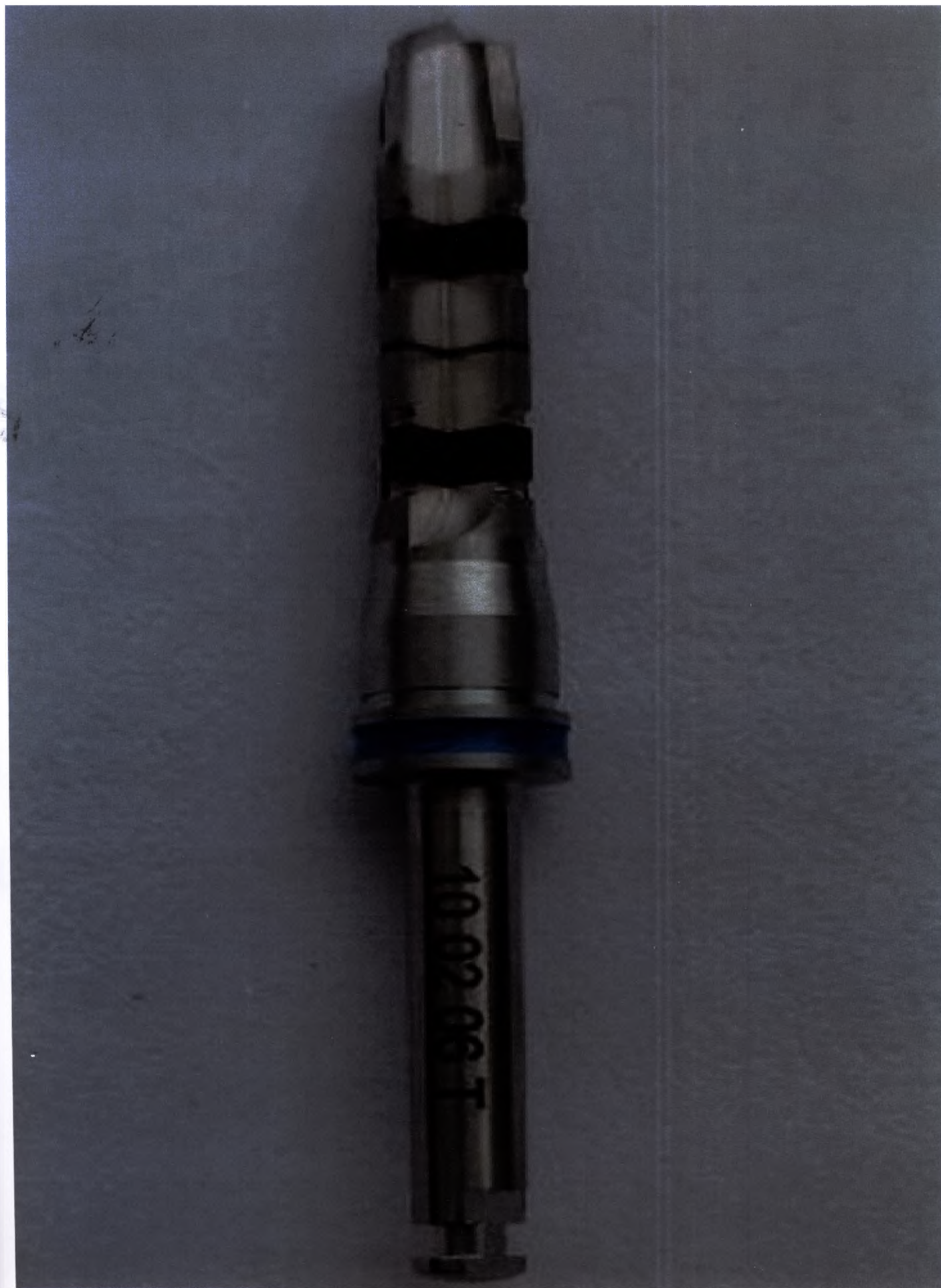
Фото 7 –Сверло с ограничителем глубины, диаметр 3,6 мм, длина 36 мм, цветовой идентификатор – синий – общий вид инструмента
