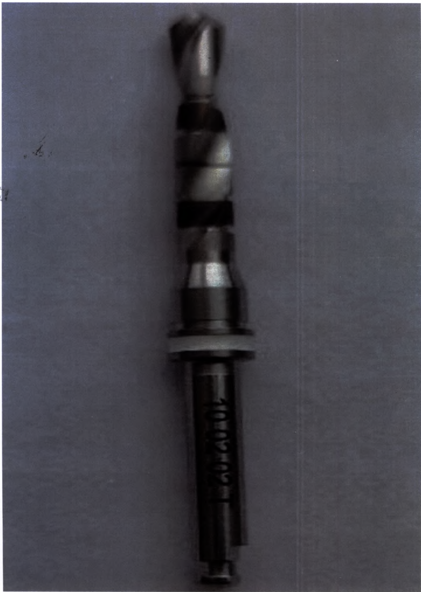
Фото 4 – Сверло стартовое с ограничителем глубины, с диаметрами 1,8-2,35 мм, длина 36мм – общий вид инструмента
