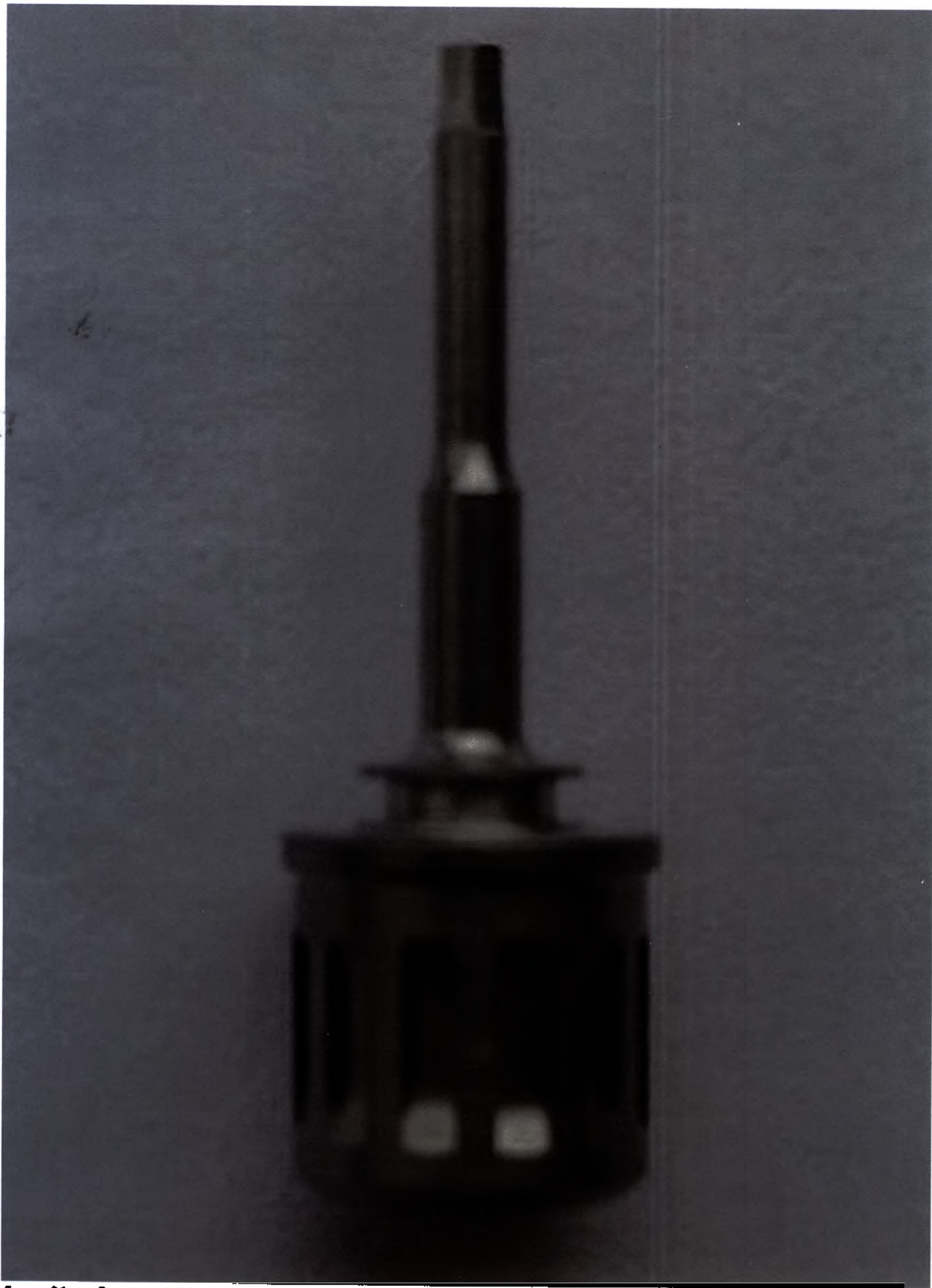
Фото 31 – Отвертка шестигранная, длинная, для ключа динамометрического, диаметром 1,2 мм – общий вид инструмента.
