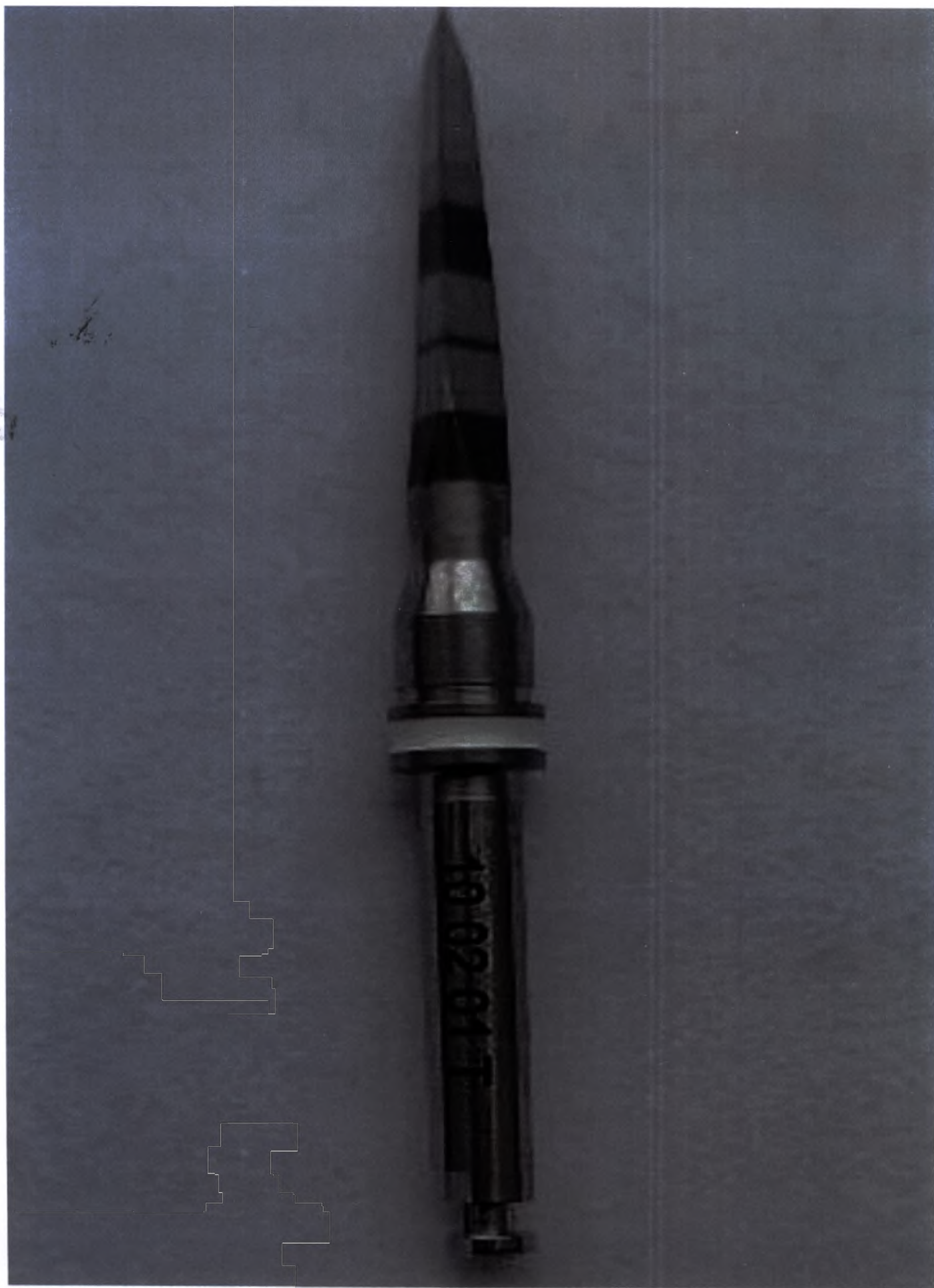
Фото 3 – Сверло прецизионное, с ограничителем глубины, диаметр 2,35 мм, длина 36 мм – общий вид инструмента
