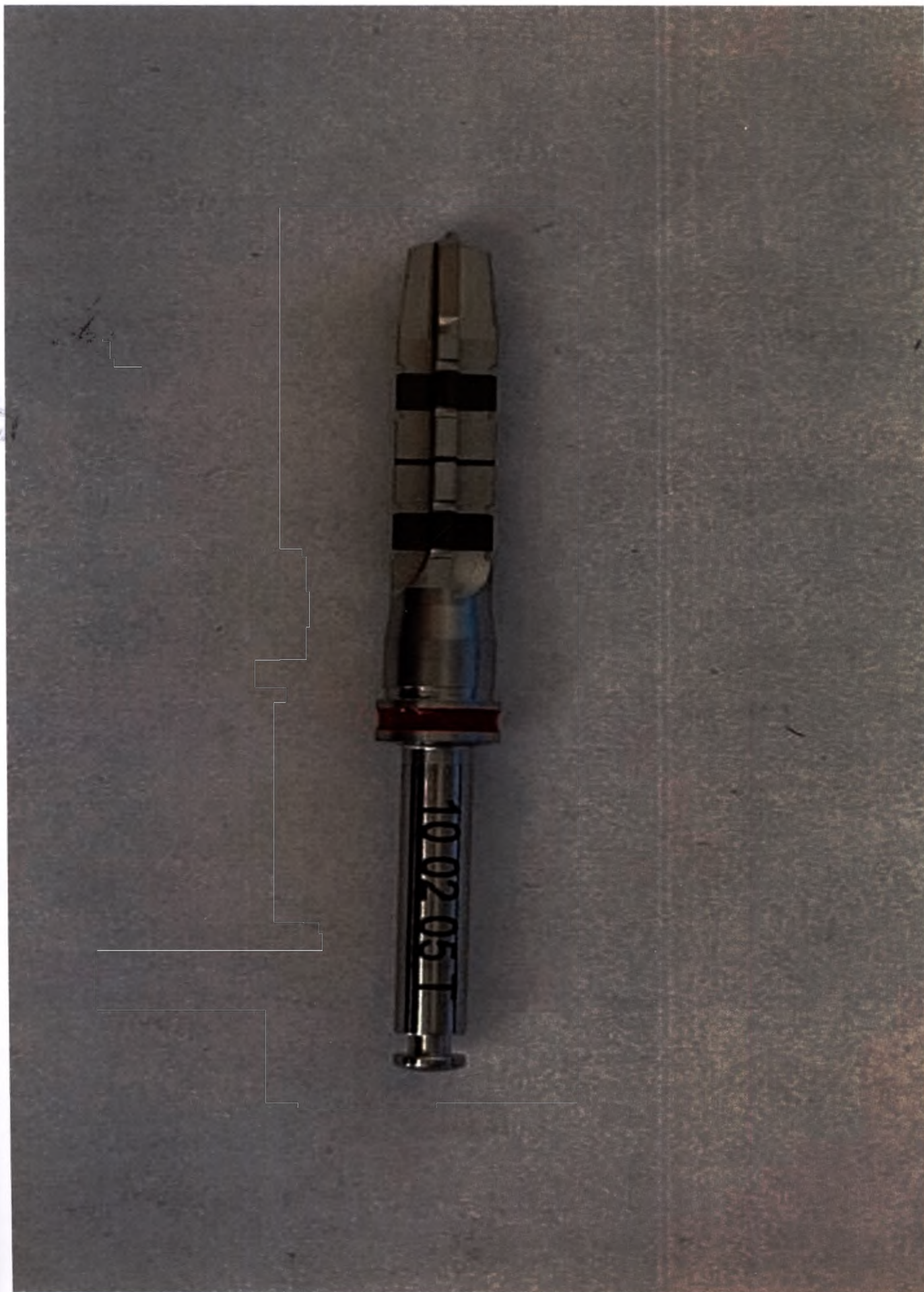
Фото 6 – Сверло с ограничителем глубины, диаметр 3,3 мм, длина 36 мм, цветовой идентификатор – красный – общий вид инструмента
