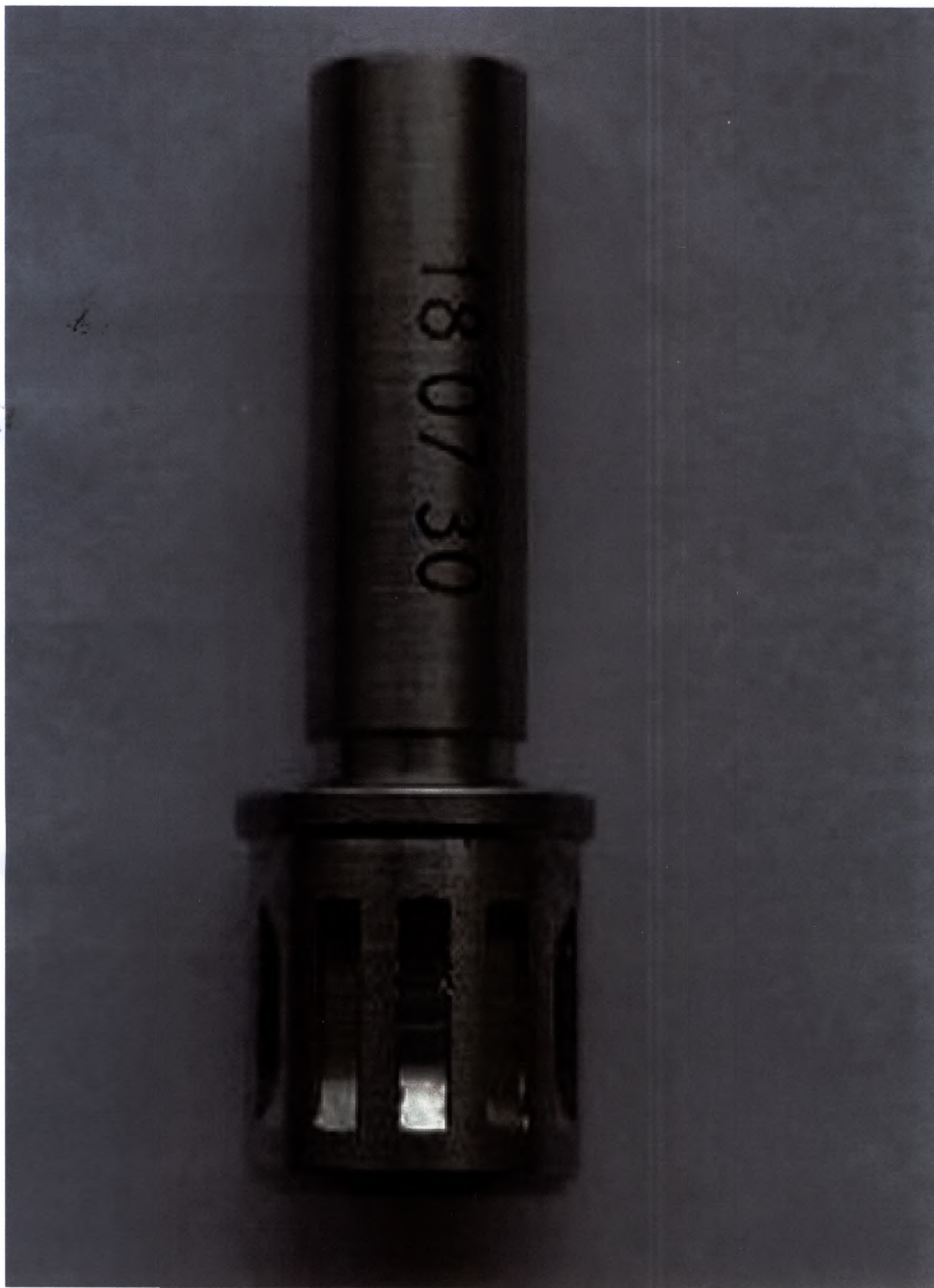
Фото 29 – Отвертка для постоянного абатмента (мостовидного протеза), диаметр 3 мм – общий вид инструмента
