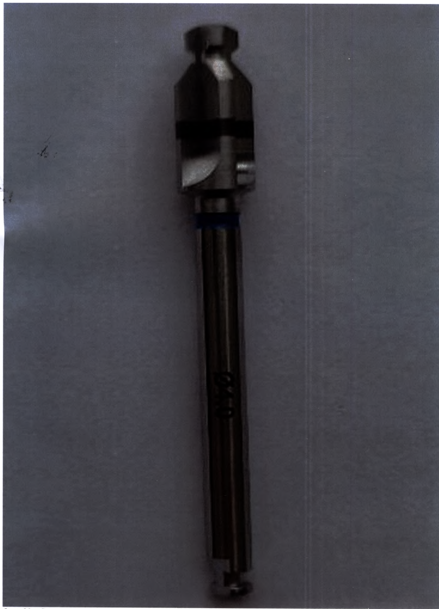
Фото 20 – Сверло для альвеолярного гребня, профильное RV, диаметр 4 мм – общий вид инструмента
