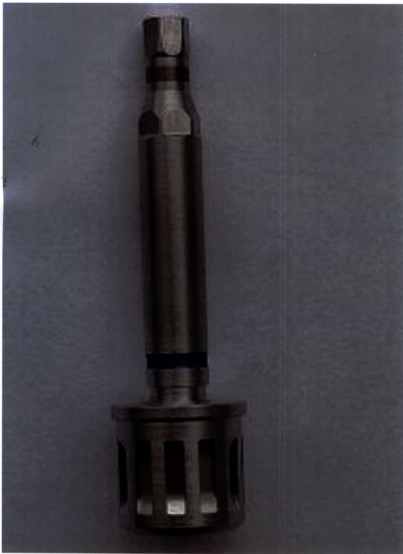
Фото 26 – Имплантовод для ключа динамометрического RV, сверхдлинный, диаметр 2,4 мм – общий вид инструмента
