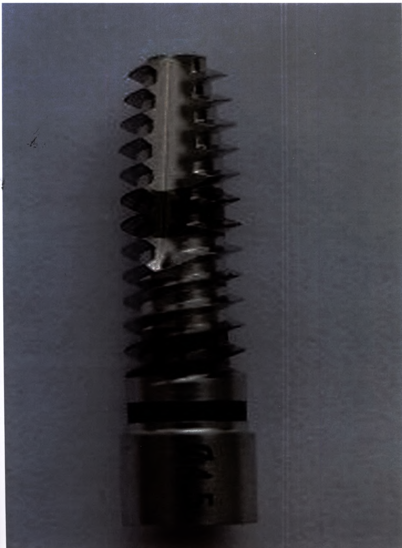
Фото 12 – Формирователь резьбы в костном канале с диаметром 4,5 мм, длиной 20,5 мм, цветовой идентификатор – черный – общий вид инструмента
