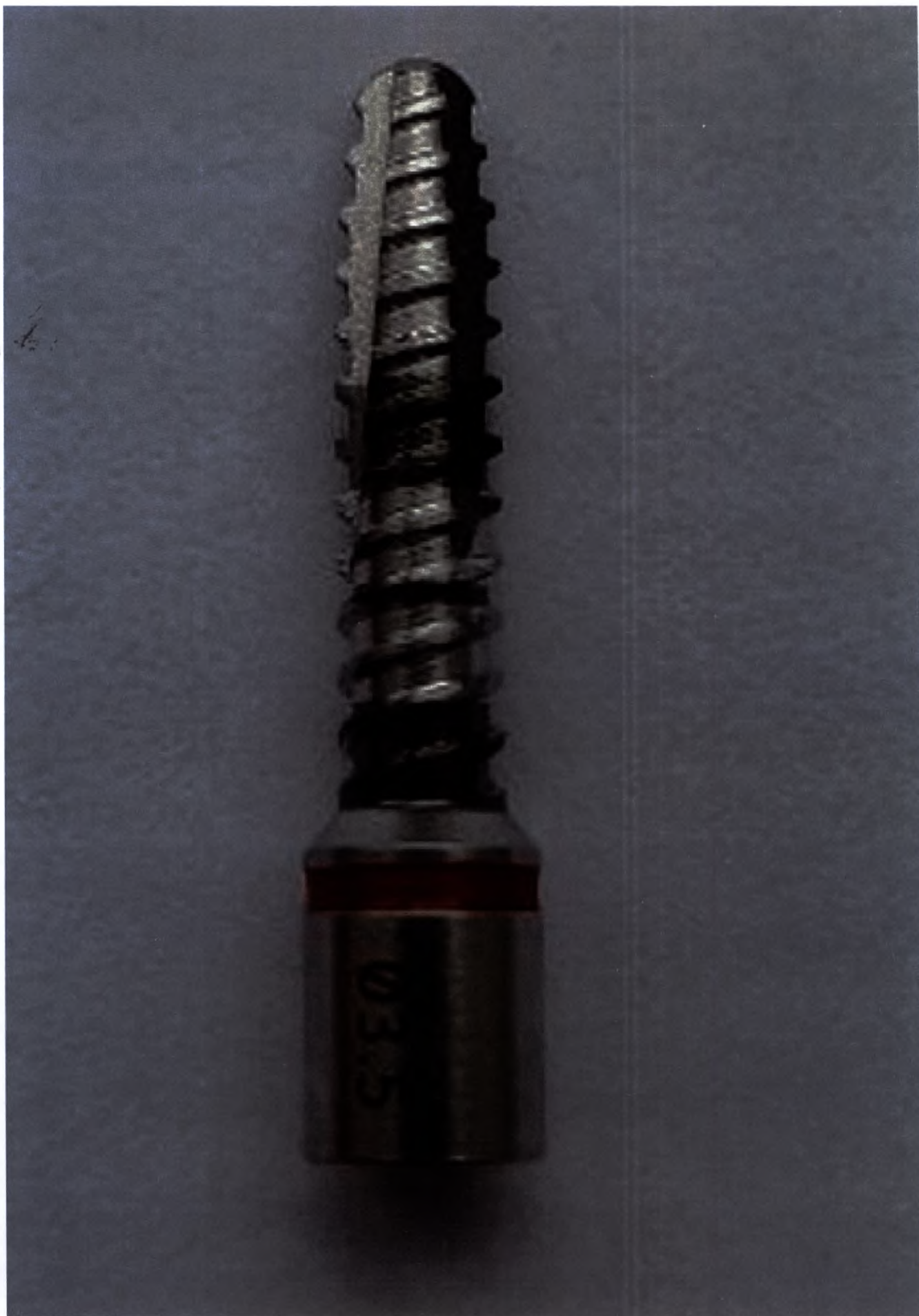
Фото 10 – Формирователь резьбы в костном канале с диаметром 3,5 мм, длиной 20,5мм, цветовой идентификатор – красный – общий вид инструмента
