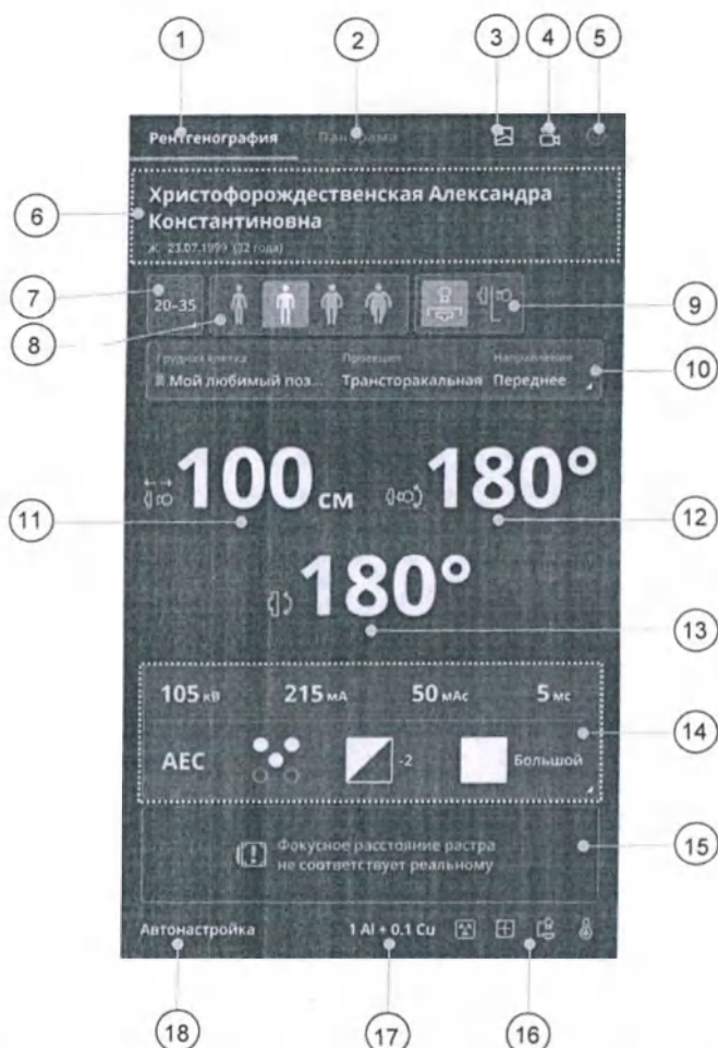
Рисунок 3.4 – Сенсорный экран пульта излучателя. Вертикальный режим отображения
