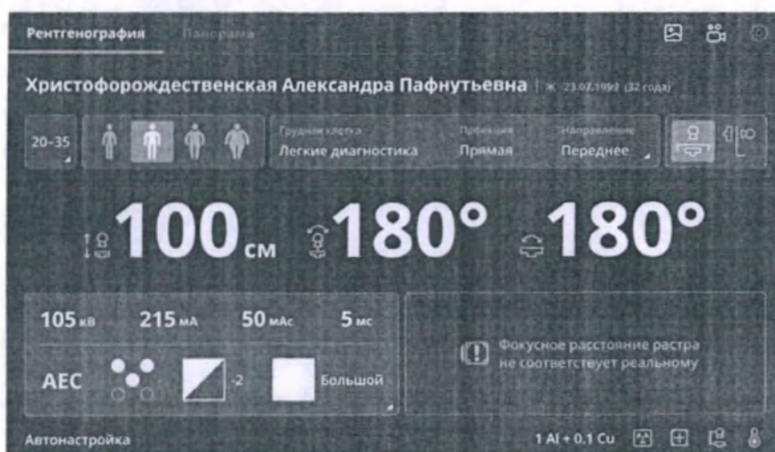
Рисунок 3.3 – Сенсорный экран пульта излучателя. Горизонтальный режим отображения
