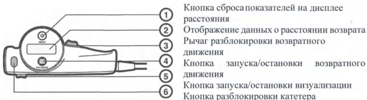
Рисунок 1-16. Элементы управления блока моторного привода
