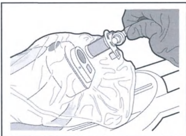
Рисунок 4. Подсоединение катетера к MDU5 PLUS
