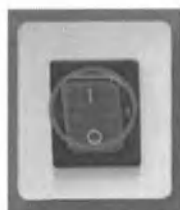
Переключатель электропитания интегрированной системы
