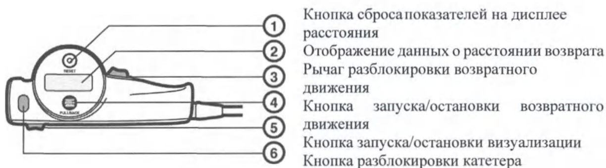
Рисунок 1-16. Элементы управления блока моторного привода
