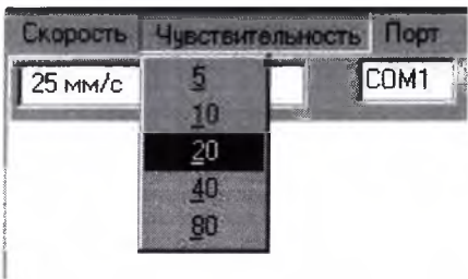
Рисунок 3.4 Настройка чувствительности развертки.
