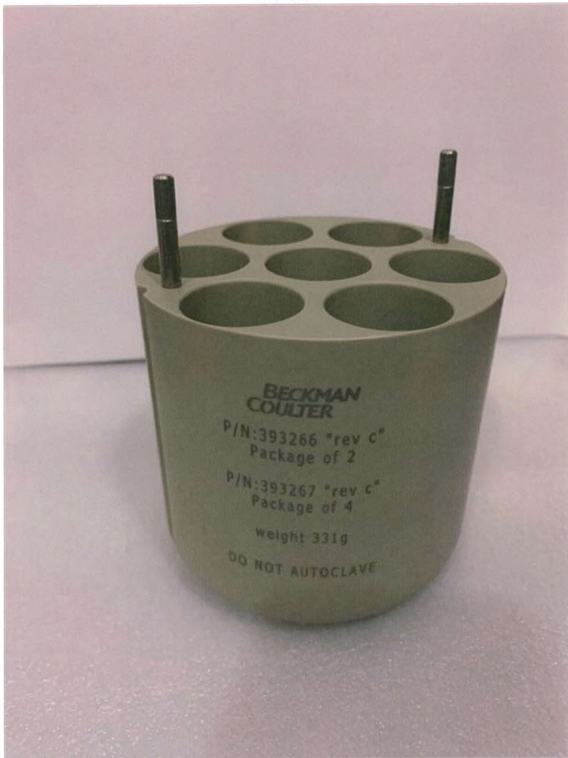
Фото 8. Цельный адаптер под конические пробирки 29 x 115 мм, 2/4шт./упаковка, не более 20 упаковок
