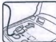
Рисунок 6.3 – АНД А15НП: Индикатор действий – Присоедините электроды одноразовые
