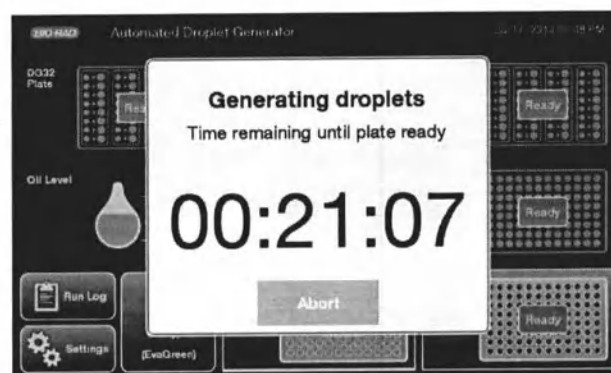
Рис. 17- А — окно инициализации в начале программы; В — окно таймера обратного отсчета, показывающий время, оставшееся до завершения генерации капель, по истечении которого можно будет вынуть планшет с каплями.
