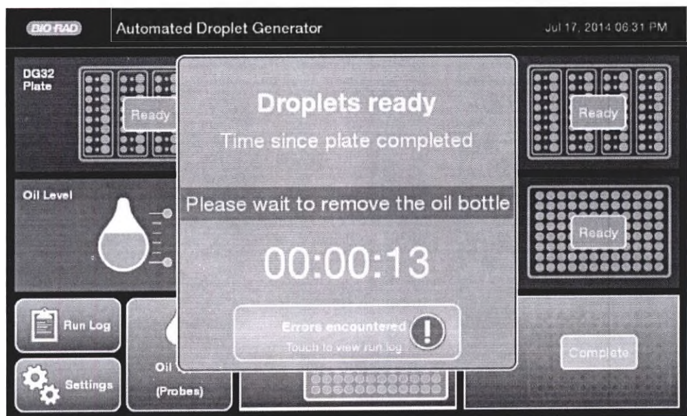
Рис. 20- Генерация капель завершена. Не извлекайте флакон с маслом, пока с экрана не исчезнет оранжевая надпись «Please wait to remove the oil bottle»
