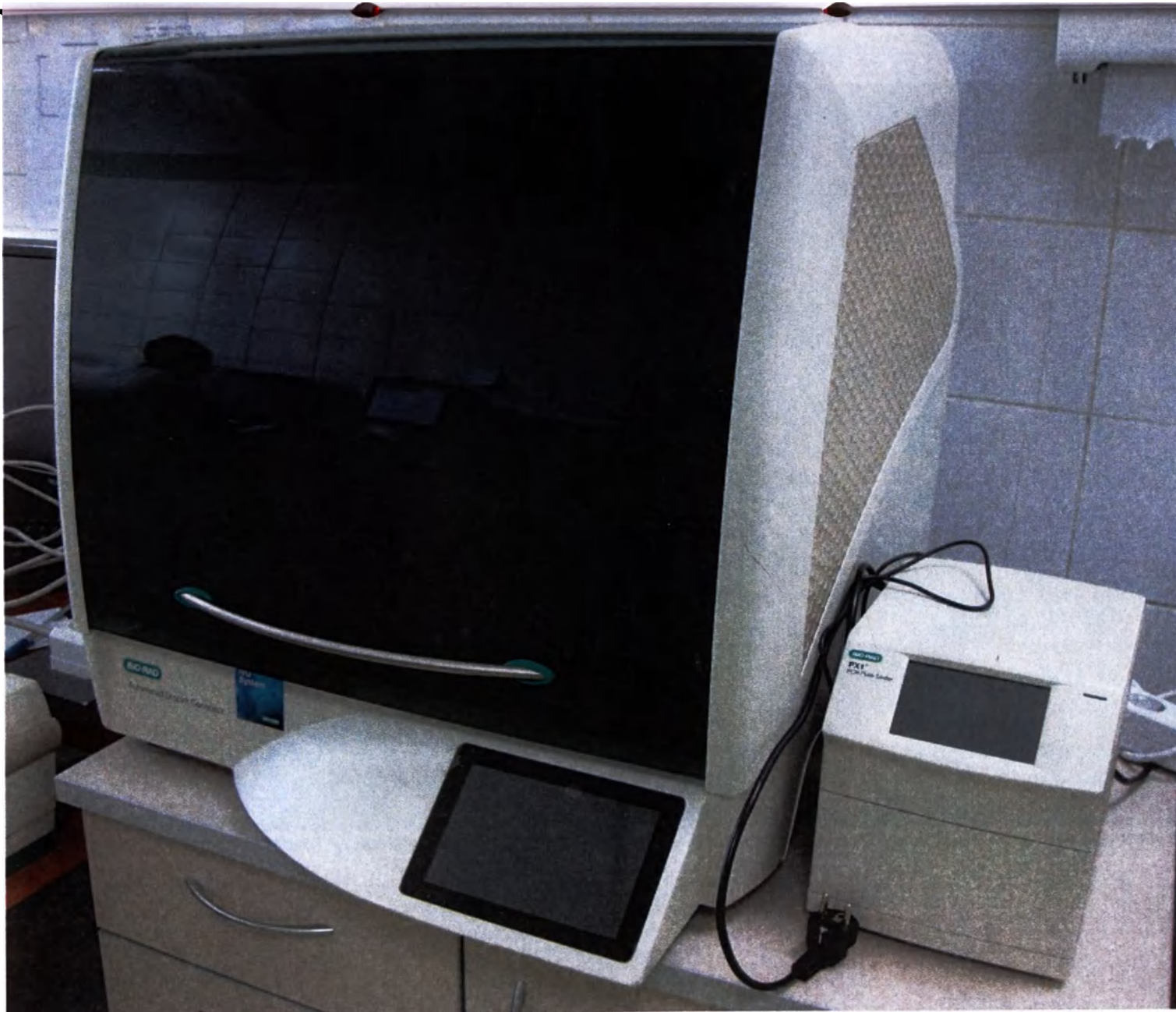
Рис. 1 Внешний вид «Генератор капель автоматический "Automated Droplet Generator" для проведения цифровой капельной ПЦР (ddPCR), с принадлежностями, в составе»
