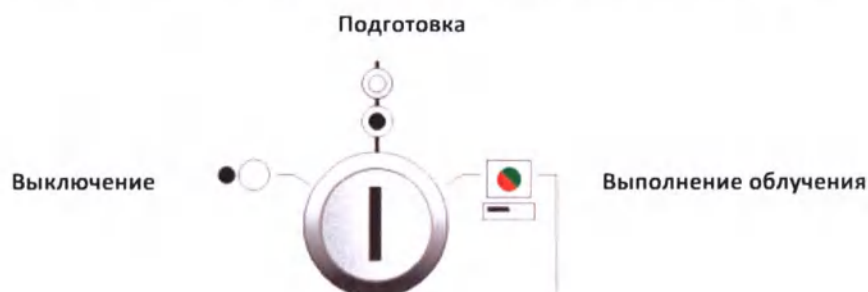
Табл. 4.1. Переключатель: положения выключения, подготовки и облучения
