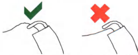
Рис. 5.23. Проведите трубку для перемещения источника над опорной планкой TDU
