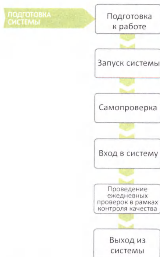
Рис. 4.2. Последовательность действий при подготовке системы к работе
