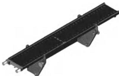
Рис. 2.1. Линейка для проверки положения источника (SPCR) с монтажной скобой
