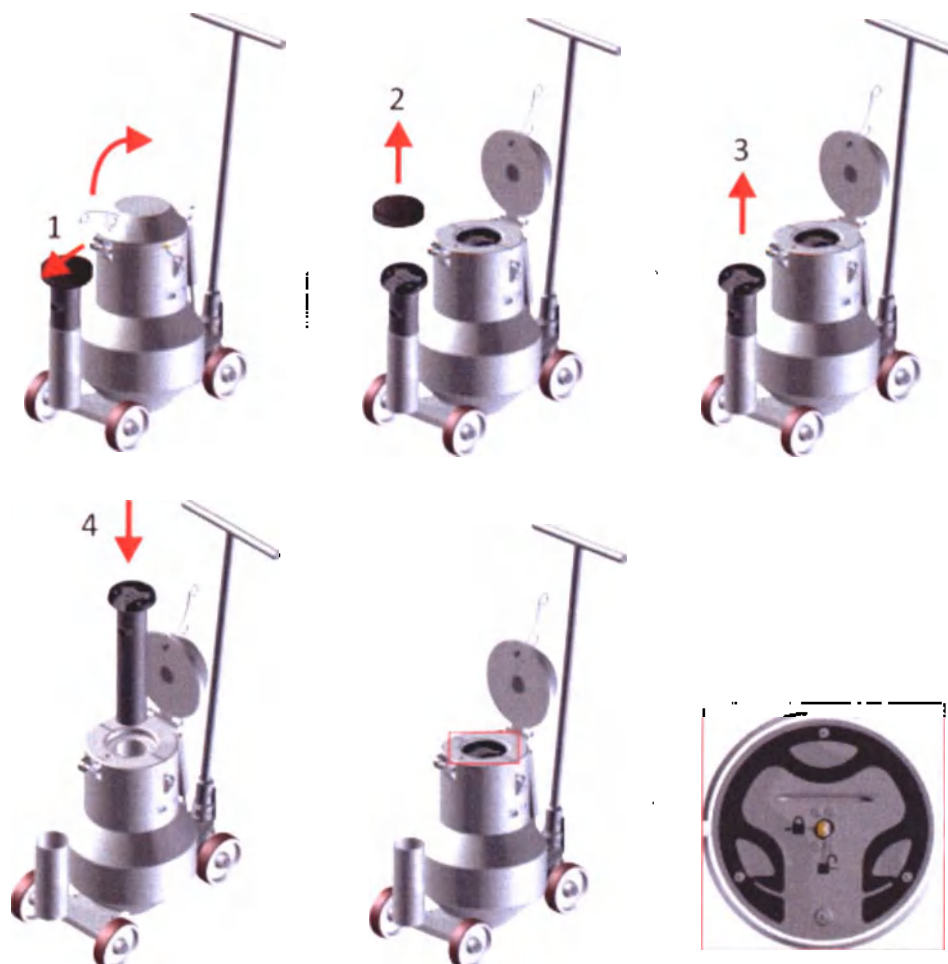
Рис. 11.3. Преобразование аварийного контейнера в транспортировочный контейнер
