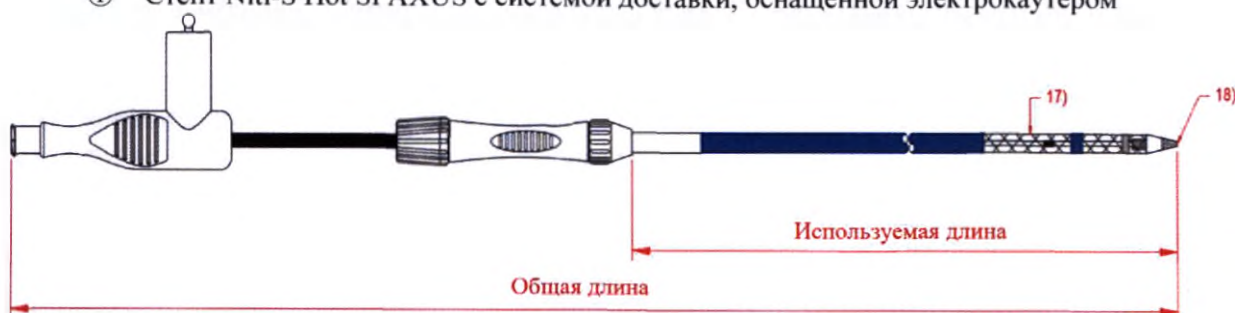
① Стент Niti-S Hot SPAXUS с системой доставки, оснащенной электрокаутером
