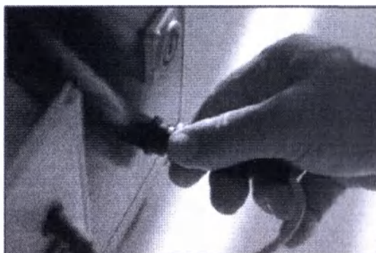
Рисунок 5.6 – Подсоединение кабелей к модулю подогрева/сушки стёкол
