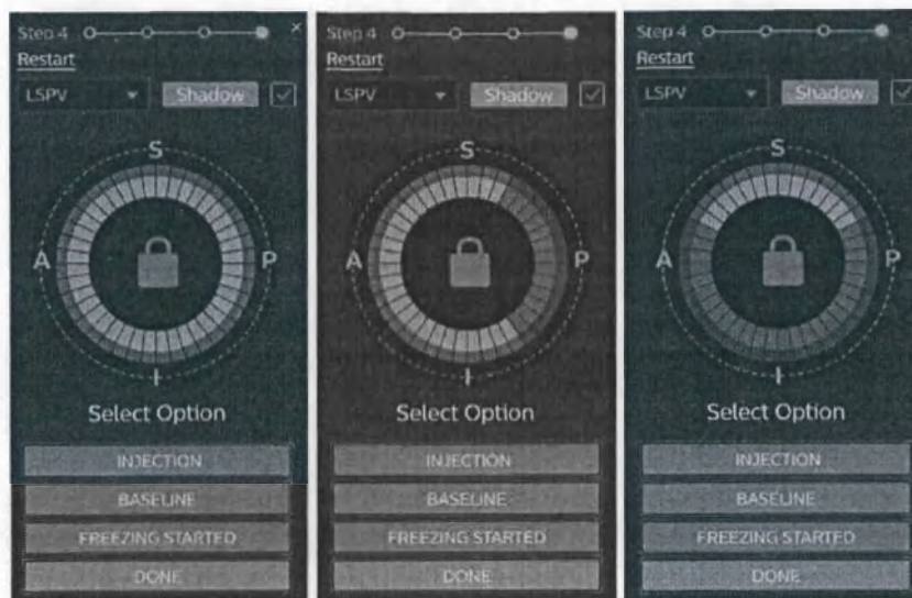
Рис. 95 Отображение примеров возможных результатов оценки при введении при наличии округлой формы катетера: окклюзия, частичная окклюзия, частичная окклюзия
