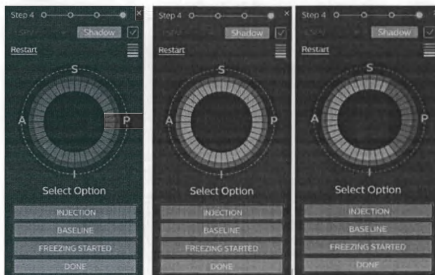
Рис. 90 Отображение примеров возможных результатов оценки по исходному положению при наличии округлой формы катетера: отсутствие окклюзии, окклюзия, частичная окклюзия
