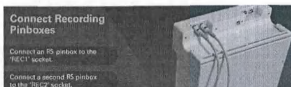
Рис. 6 Подключение блоков контактов системы регистрации
