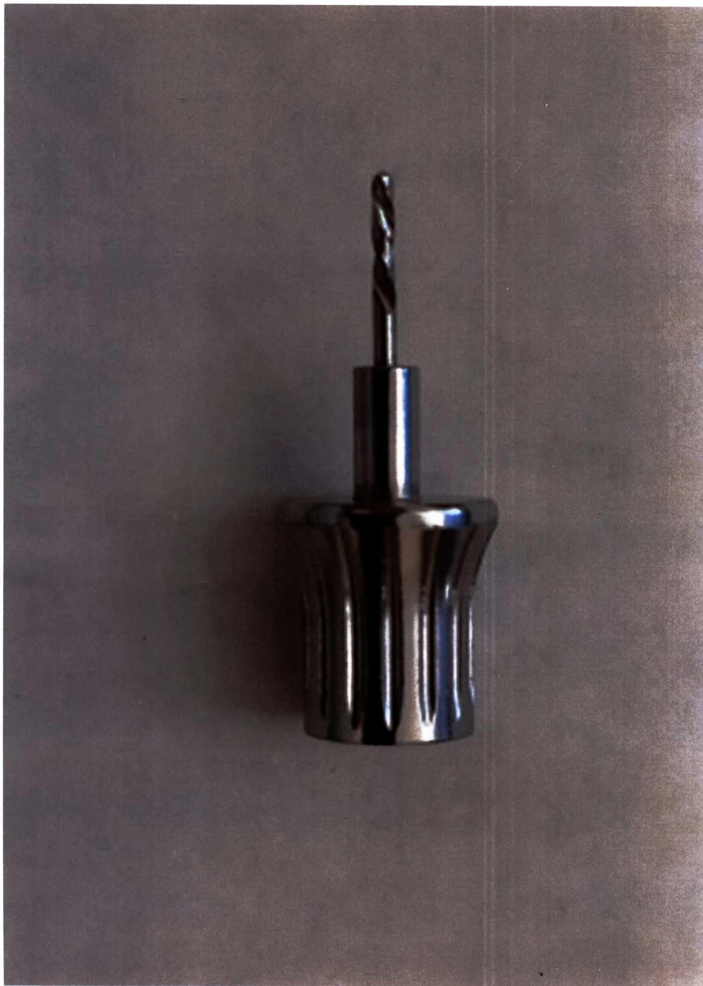
Фото 2 – Сверло левостороннего вращения с ручным управлением – внешний вид медицинского изделия
