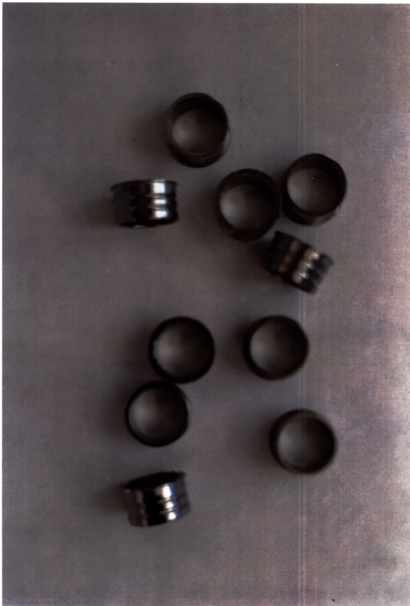
Фото 3 – Кольцо направляющее диаметр 6,4 мм, высотой 3,5 мм – внешний вид медицинского изделия
