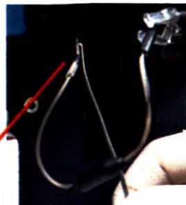
Рис. 7.9. Отсоединение трубки образца от референтного электрода
