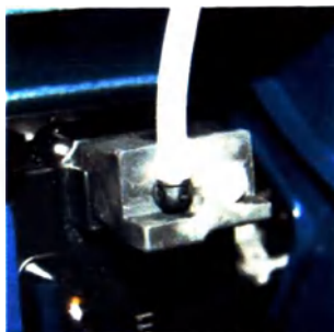
Рисунок 8.3 Подключение адаптера трубкой вверх.
