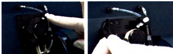
Рис. 7.3 Освобождение прижимной пластины трубок насоса
