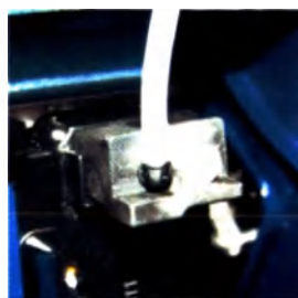
Рисунок 8.3 Подключение адаптера трубкой вверх.
