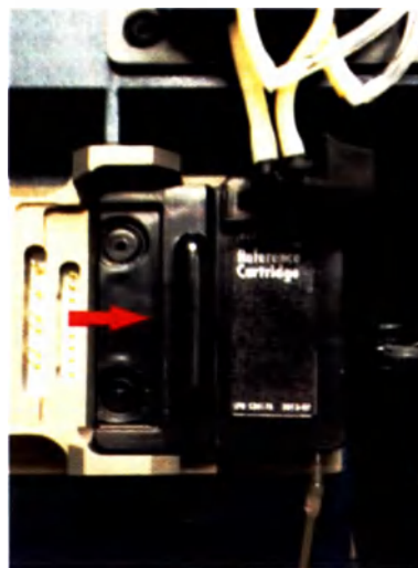
Рис. 7.13. Снятие референтного электрода
