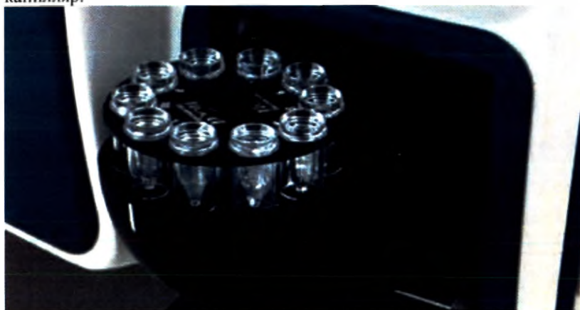
В лотке для проб с 10 чашками размещаются образцы сыворотки, плазмы и мочи.
