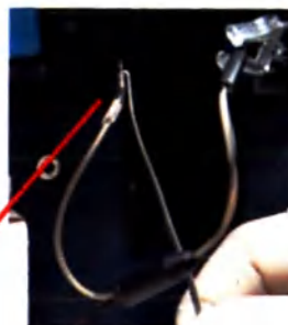
Рис. 7.9. Отсоединение трубки образца от референтного электрода
