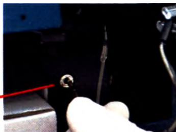
Рис. 7.8. Отсоединение кабеля воздушного детектора
