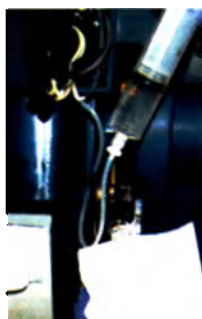
Рис. 8.5. Промывка проточных каналов.
