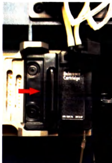
Рис. 7.13. Снятие референтного электрода
