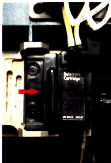
Рис. 7.13. Снятие референтного электрода
