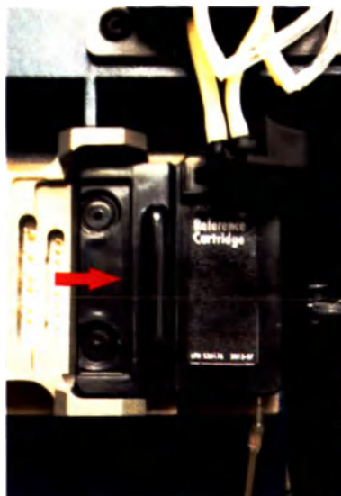
Рис. 7.13. Снятие референтного электрода
