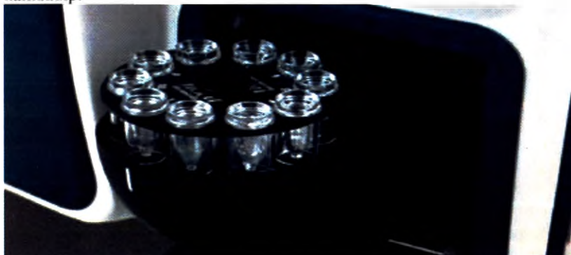
Образцы можно отбирать непосредственно из пробирок. При этом исключается переливание образца в шприц или капилляр.
