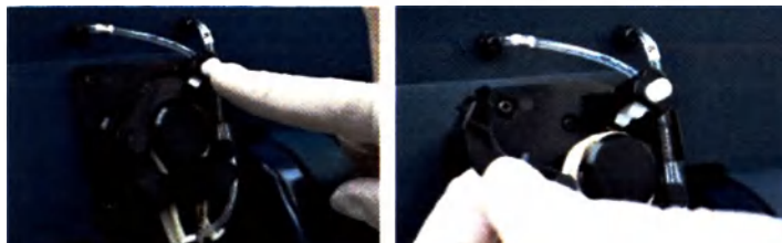
Рис. 7.3 Освобождение прижимной пластины трубок насоса
