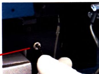
Рис. 7.8. Отсоединение кабеля воздушного детектора
