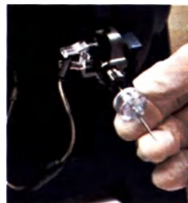
Рис. 7.7. Снятие капиллярного адаптера
