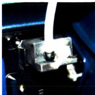
Рисунок 8.3 Подключение адаптера трубкой вверх.
