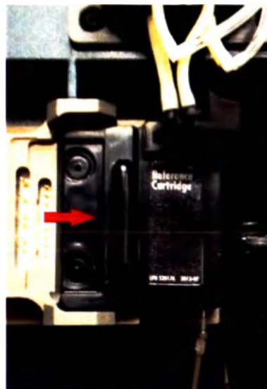
Рис. 7.13. Снятие референтного электрода
