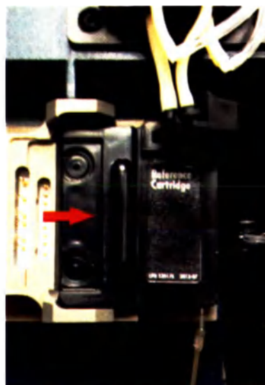
Рис. 7.13. Снятие референтного электрода
