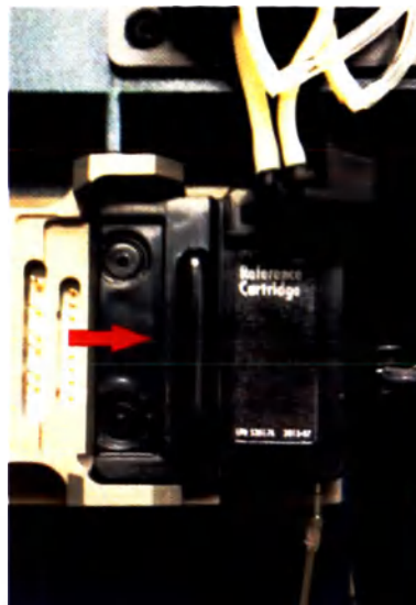
Рис. 7.13. Снятие референтного электрода
