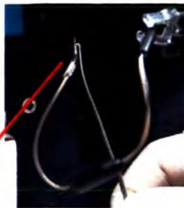
Рис. 7.9. Отсоединение трубки образца от референтного электрода
