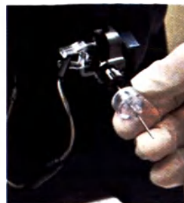
Рис. 7.7. Снятие капиллярного адаптера
