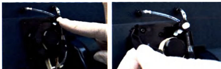
Рис. 7.3 Освобождение прижимной пластины трубок насоса
