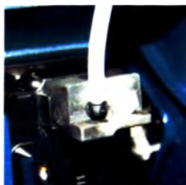
Рисунок 8.3 Подключение адаптера трубкой вверх.
