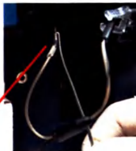
Рис. 7.9. Отсоединение трубки образца от референтного электрода
