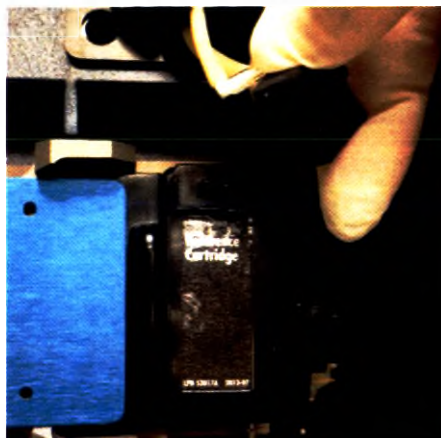
Рис. 7.5. Подключение коннектора трубок к референтному электроду.
