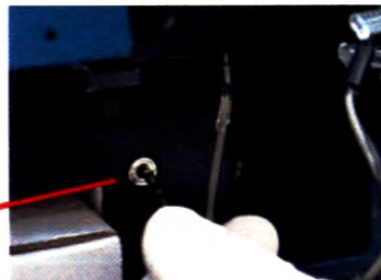
Рис. 7.8. Отсоединение кабеля воздушного детектора
