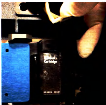
Рис. 7.5. Подключение коннектора трубок к референтному электроду.
