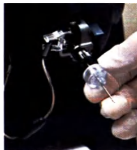
Рис. 7.7. Снятие капиллярного адаптера
