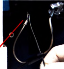
Рис. 7.9. Отсоединение трубки образца от референтного электрода
