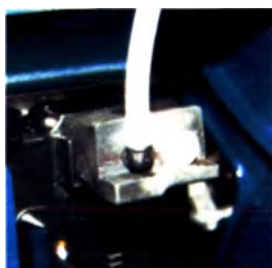
Рисунок 8.3 Подключение адаптера трубкой вверх.
