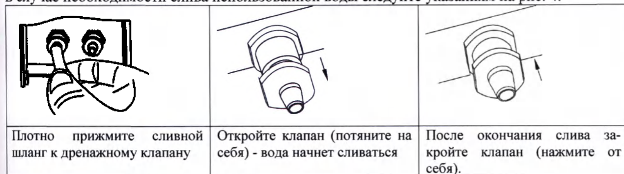
Рис. 4. Порядок слива использованной воды из бака стерилизатора.
