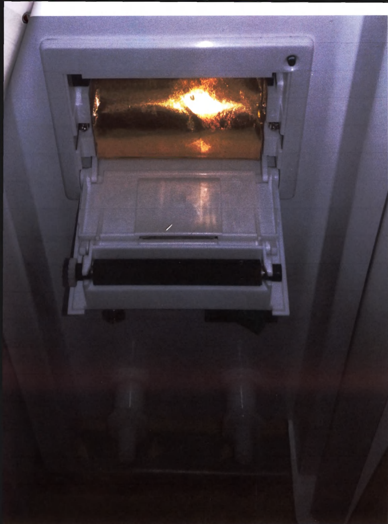
Рис. 17. Встроенный принтер с установленным рулоном бумаги для принтера.
