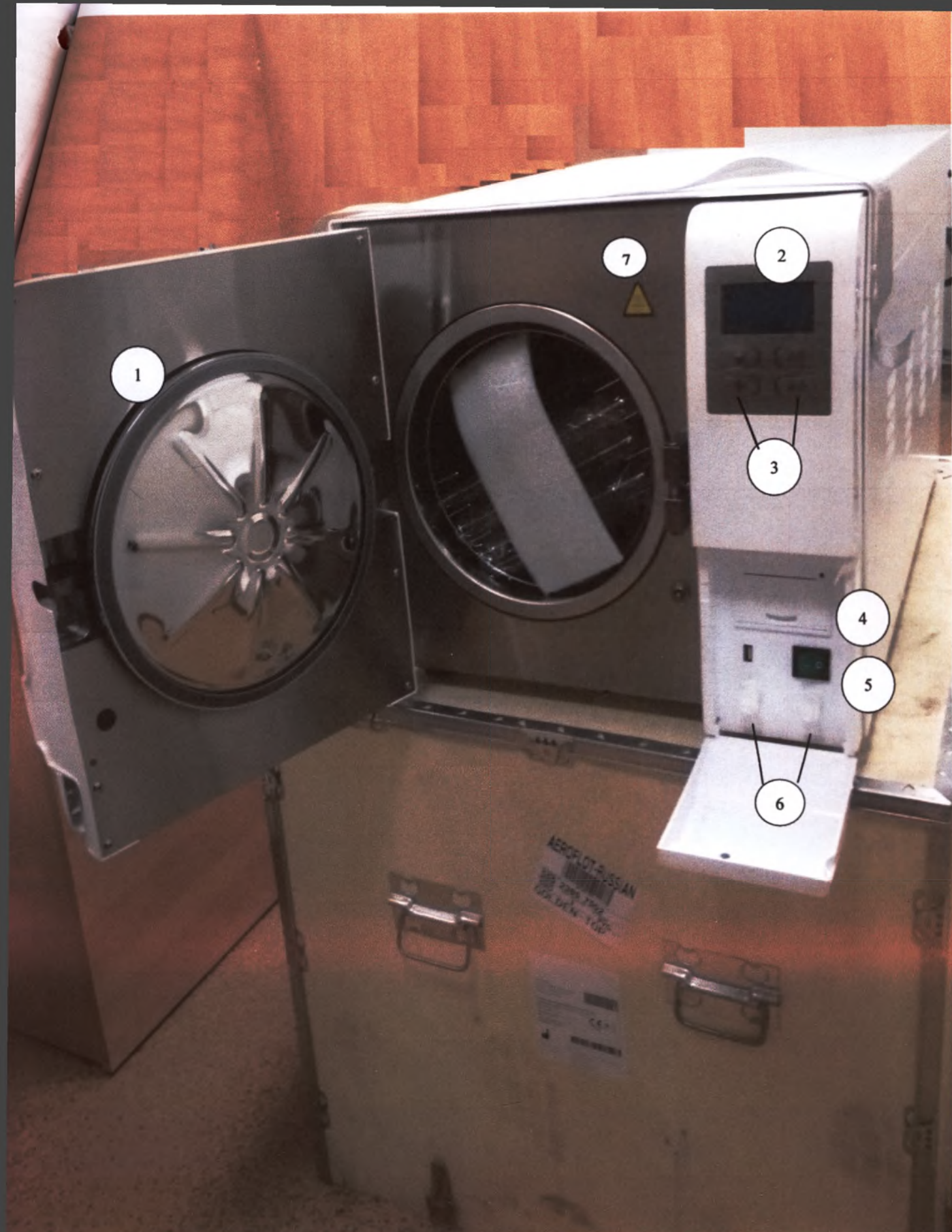
Рис. 6. Основные функциональные элементы (идентичны для STE-8-D, STE-18-D, STE-23-D, STE-29-D. Уплотнительное кольцо дверцы (1); ЖК-дисплей (2); Кнопки меню дисплея (3); Встроенный принтер (4); Кнопка Вкл/Выкл питания (5); Разъем для слива дистиллированной воды (справа) и Разъем для слива (отработанная вода) (слева) (6); Символ «Осторожно! Высокая температура в камере и на поверхности стерилизатора» (7)
