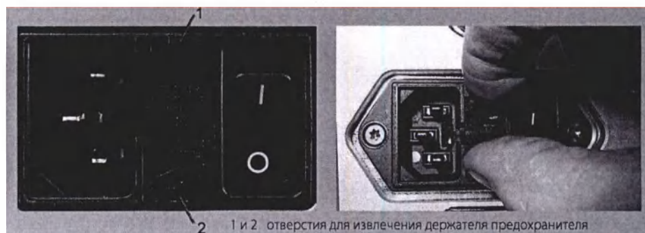
Рис. 5-1 Соединитель для подключения к сети, держатель предохранителя, сетевой выключатель
