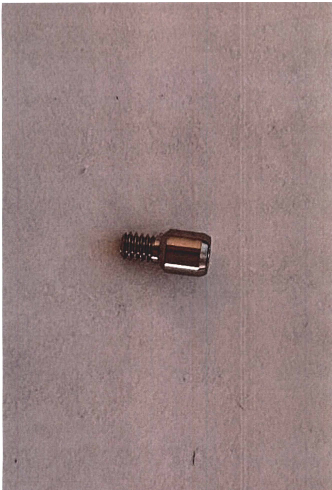
Фото 5 – Микро-винт крепежный звездчатый, длина 4,5 мм, - вид медицинского изделия
