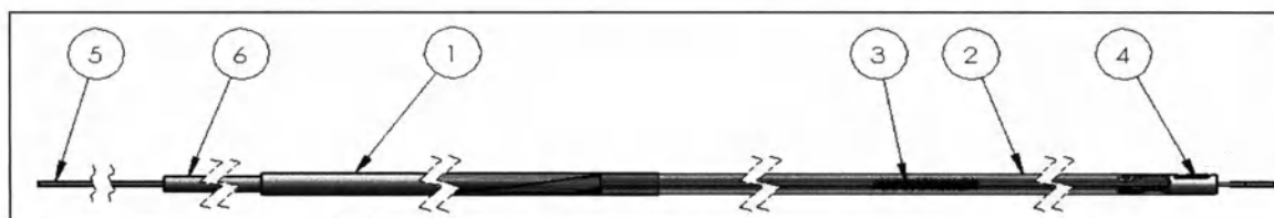
Рисунок 11 – Конструкция толкателя для отделения
