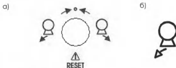
Рисунок 2.38 – Джойстик управления наклоном колонны и сброса ошибок (а) и кнопка наклона колонны к голове на панели управления стола-штатива (б)
