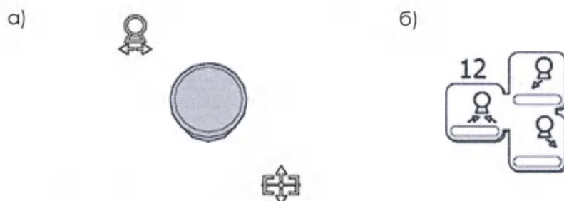
Рисунок 2.7 – Джойстик для регулировки движения деки и каретки (а) и кнопка возврата колонны в вертикальное положение 12 на панели управления (б)
