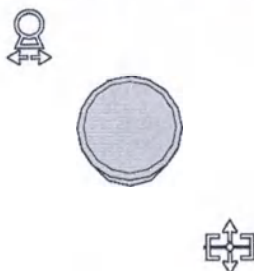
Рисунок 2.12 – Джойстик для регулировки движения деки и каретки на консоли управления стола-штатива
