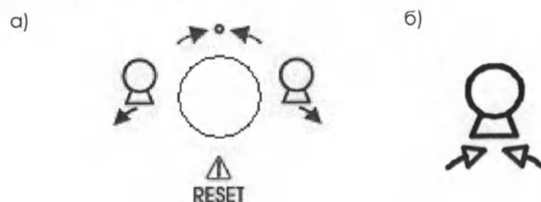
Рисунок 2.40 – Джойстик управления наклоном колонны и сброса ошибок (а) и кнопка возврата колонны в вертикальное положение на панели управления стола-штатива (б)
