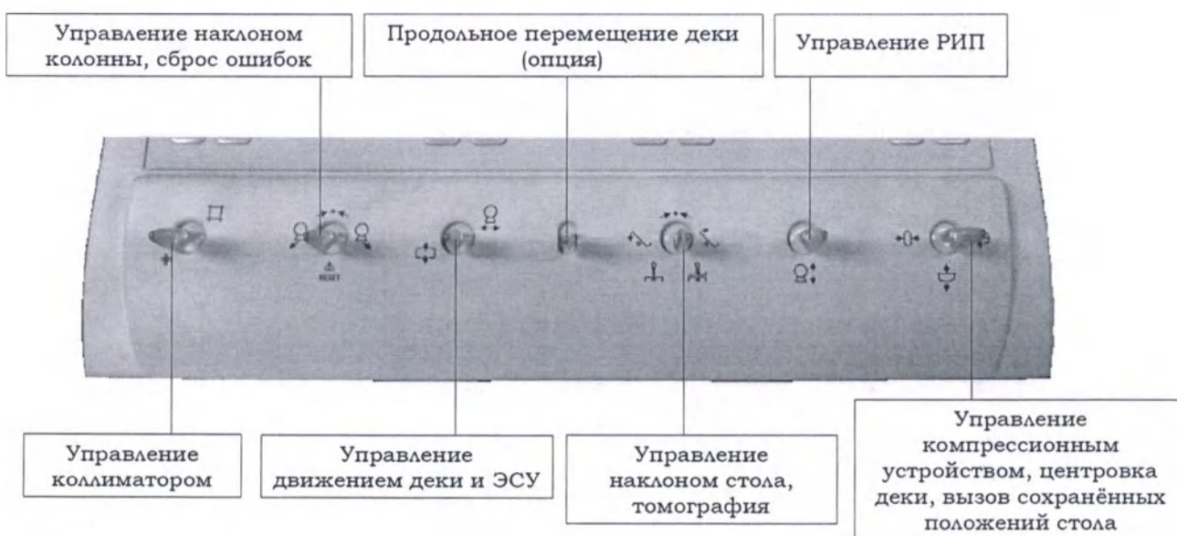
Рисунок 1.28 – Джойстики мембранной консоли управления стола-штатива Apollo EZ
