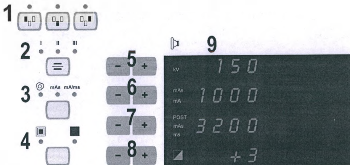
Рисунок 1.73 – Кнопки параметров рентгенографии на мембранной консоли управления РПУ
