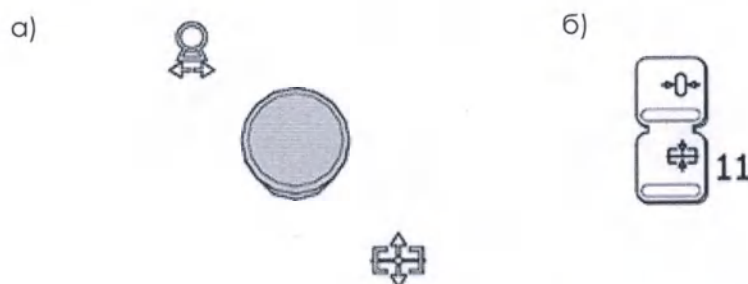
Рисунок 2.6 – Джойстик для регулировки движения деки и каретки (а) и кнопка центровки деки стола 11 на панели управления (б)
