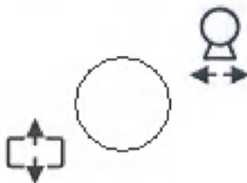
Рисунок 2.41 – Джойстик управления продольным перемещением ЭСУ и поперечным перемещением деки стола на мембранной консоли управления стола-штатива
