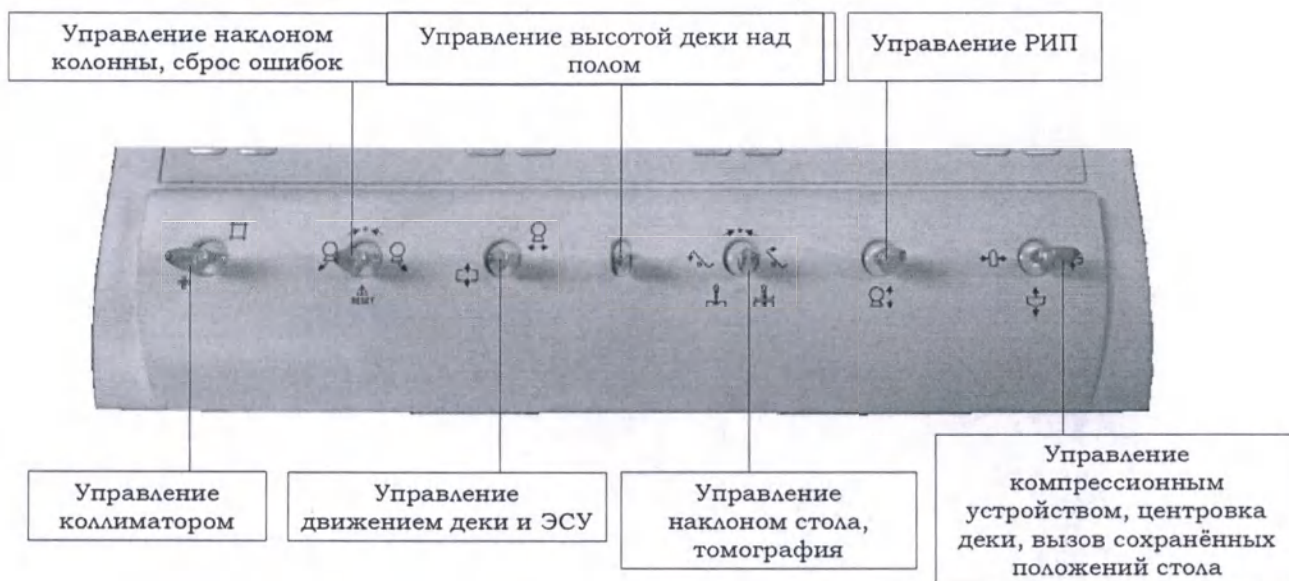
Рисунок 1.27 – Джойстики мембранной консоли управления стола-штатива Apollo
