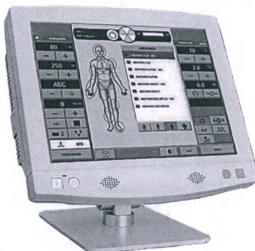
Рисунок 1.76 – Тач-скрин консоль управления РПУ
