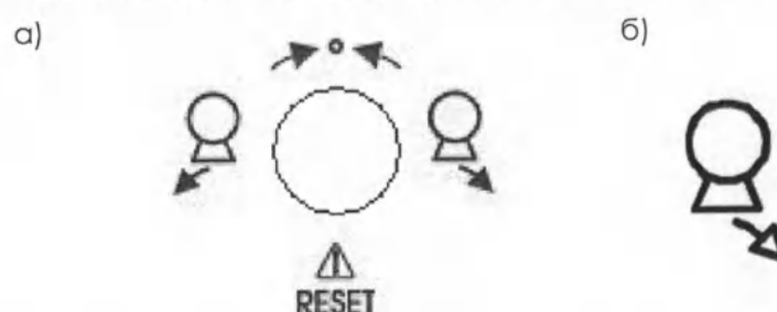
Рисунок 2.39 – Джойстик управления наклоном колонны и сброса ошибок (а) и кнопка наклона колонны к ногам на панели управления стола-штатива (б)
