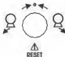
Рисунок 1.30 – Джойстик управления наклоном колонны и сброса ошибок на мембранной консоли управления стола-штатива
