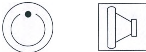
Рисунок 1.78 – Кнопки предэкспозиции и экспозиции на тач-скрин консоли управления РПУ
