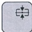
Рисунок 2.4 – Кнопка центровки деки стола на консоли управления стола-штатива
