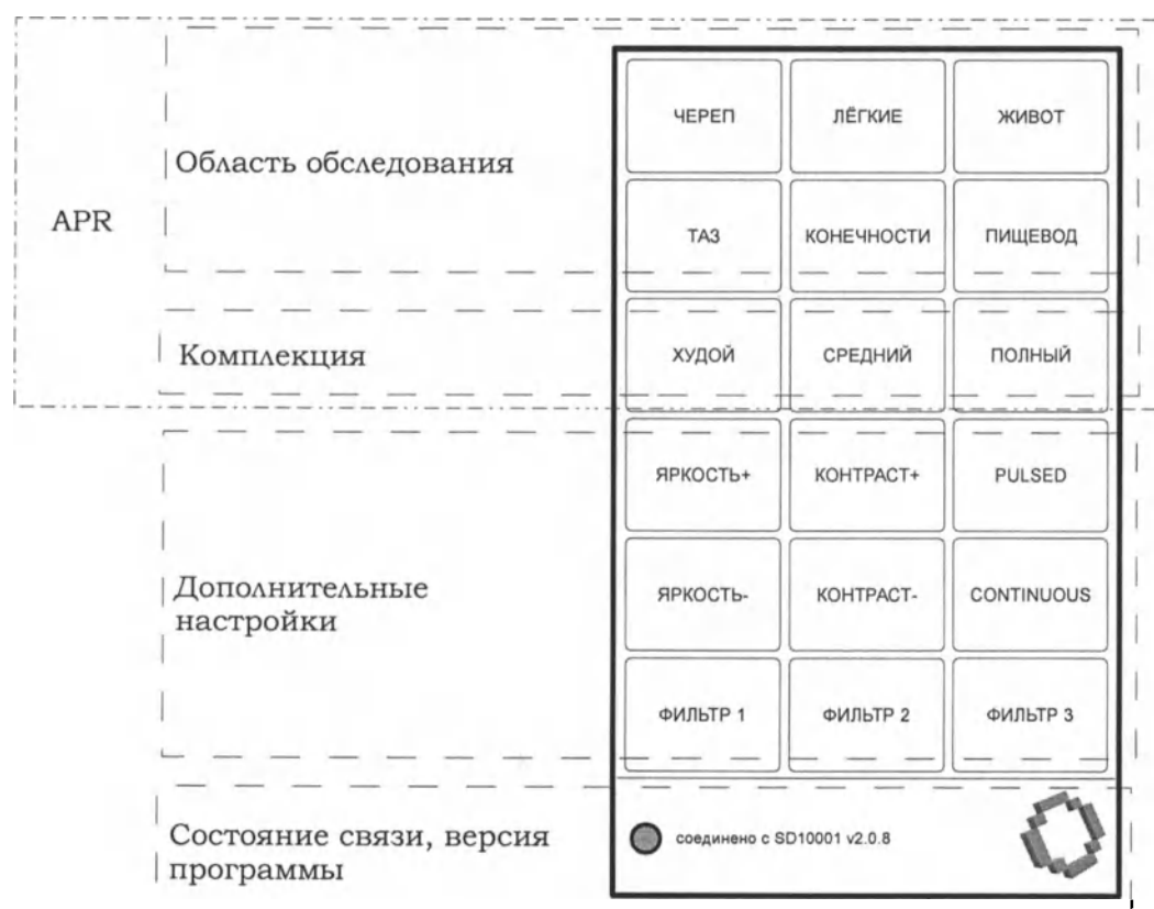
Рисунок 1.58 – Области кнопок главного меню пульта консоли управления РПУ
