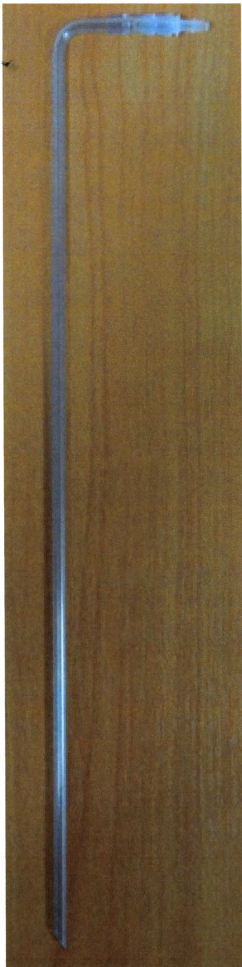
Трубка для подключения дилуэнта
