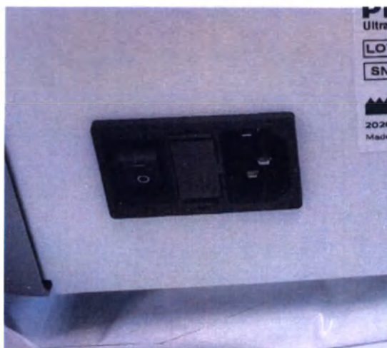
Основные элементы специального сканера UFS: выключатель [ON/OFF] (Вкл/Выкл) и гнездо для подключения кабеля питания
