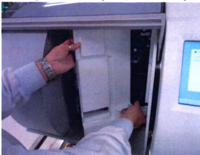
Высвобождение крышки предметного столика
