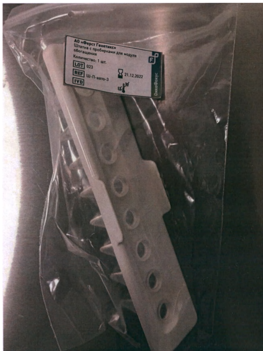
2.3.5.3. Штатив с пробирками для модуля обогащения
