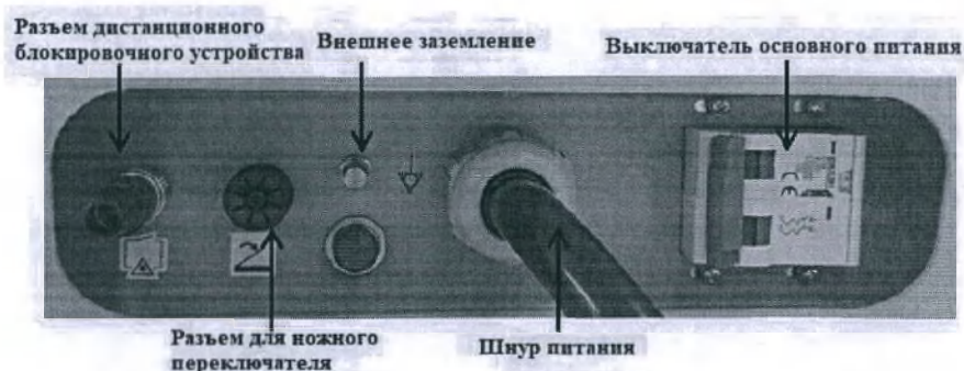
Рисунок 4.18 Выключатель основного питания, разъемы для дистанционного блокировочного устройства и ножного переключателя
