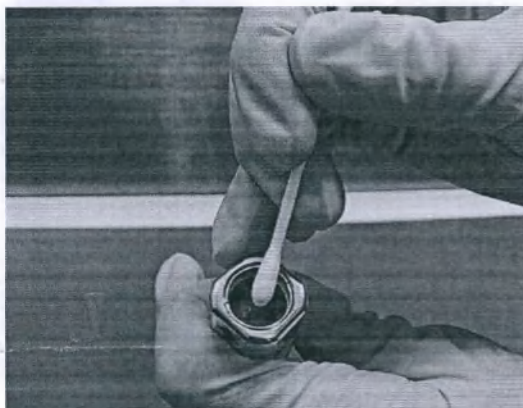
Рисунок 6.5 Очистка линзы картриджа ватной палочкой
