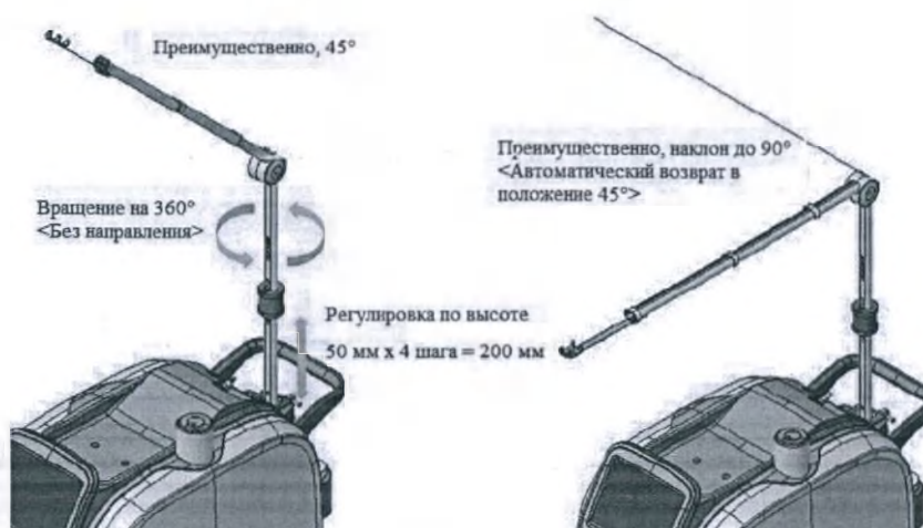
Рисунок 4.2 Установка стойки для оптоволоконного кабеля
