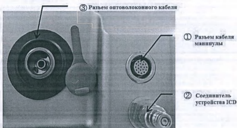
Рисунок 4.4 Подключение оптоволоконного кабеля криогенного интеллектуального устройства охлаждения
