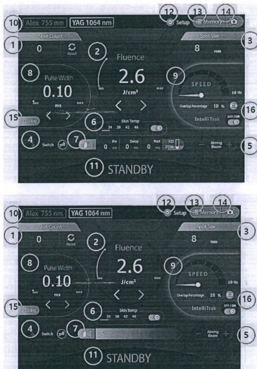
Рисунок 5.2 Панель управления неодимового лазера (1064 нм) в режиме IntelliTrak с использованием криогенного интеллектуального устройства охлаждения (верхний рисунок), устройства воздушного охлаждения (нижний рисунок)
