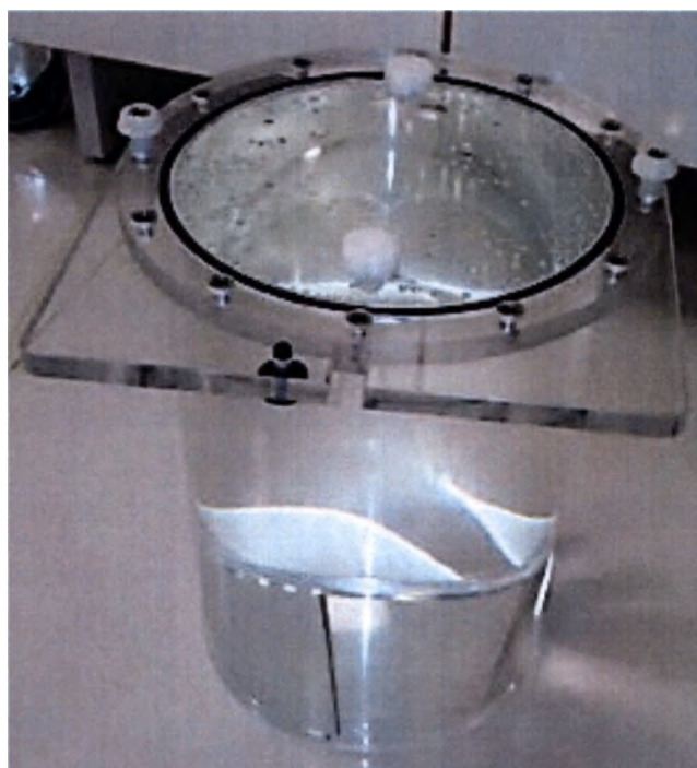
Рисунок 59 – Фотографическое изображение однородного цилиндрического фантома для выполнения калибровки SUV.
