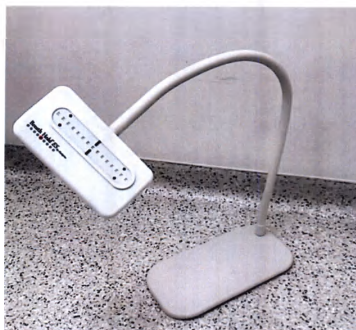
Рисунок 36 – Фотографические изображения монтажных кронштейнов (без/с дыхательным монитором), входящих в состав интерактивной системы контроля задержки дыхания для четырехмерного пульмонологического сканирования
