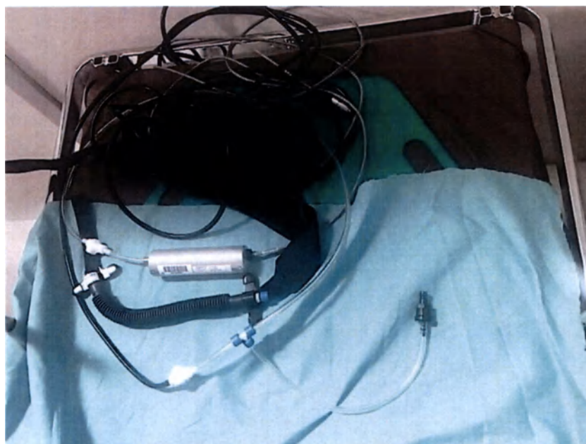
Рисунок 27 – Фотографическое изображение мембранного датчика, входящего в состав интерактивной системы контроля задержки дыхания для четырехмерного пульмонологического сканирования.
