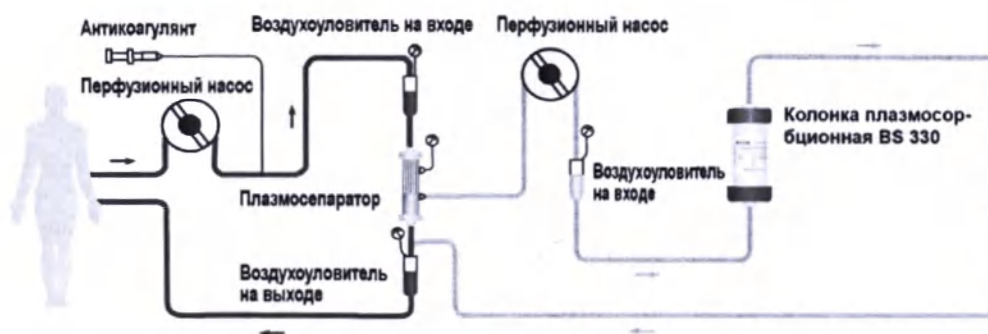
Схема процесса адсорбции плазмы
