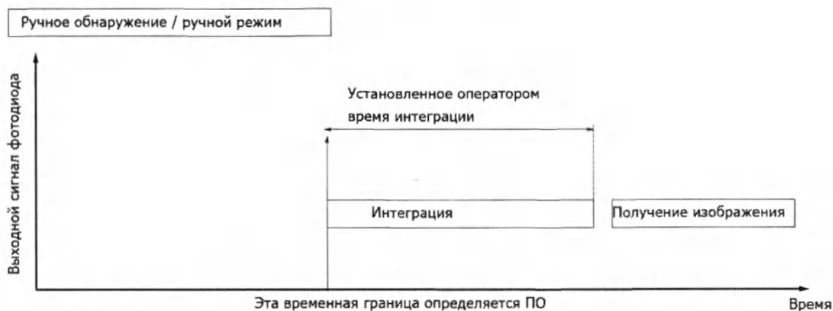
Рисунок 5 – Установка времени интеграции (рентгеновского излучения нет)
