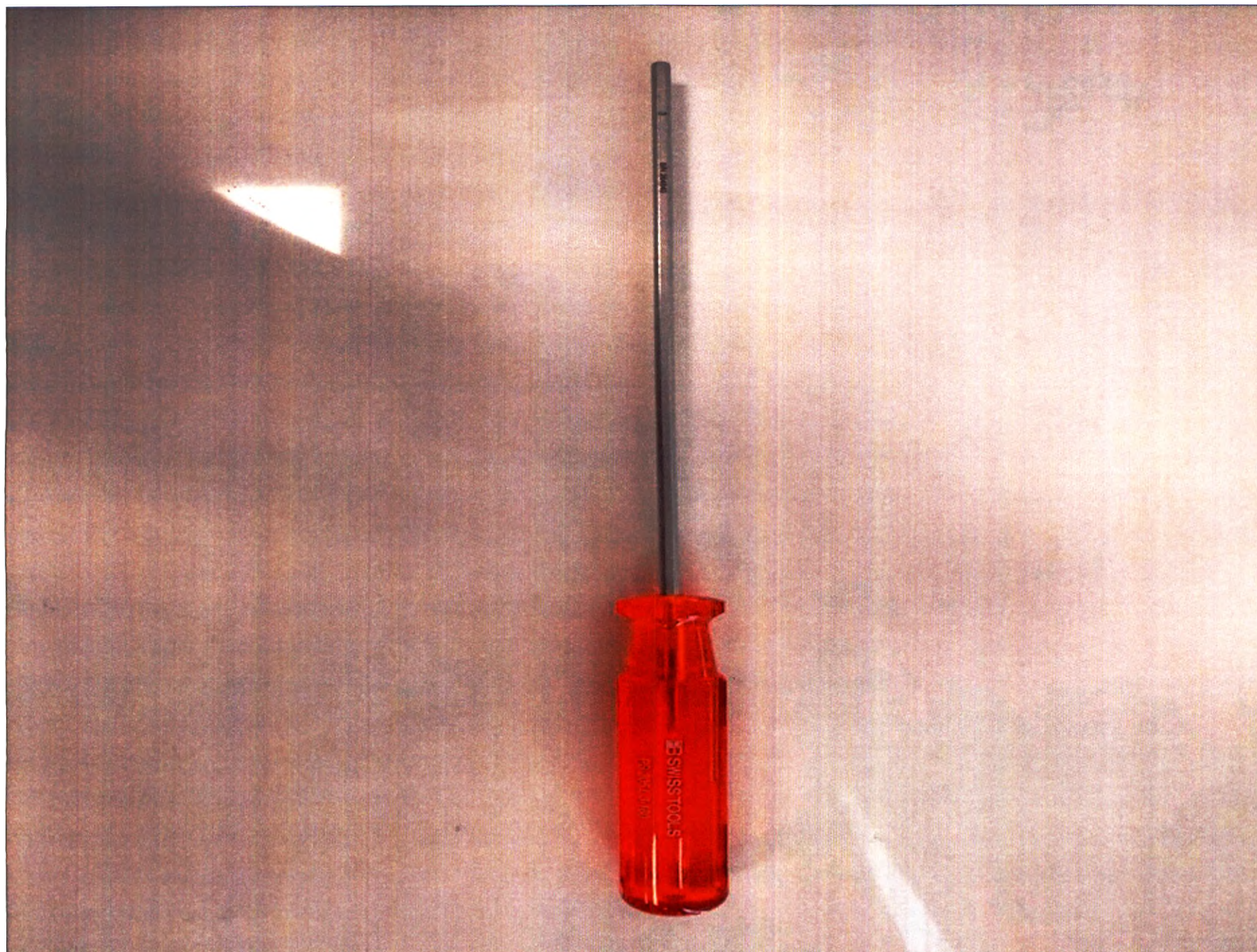
Рис. 27. Шестигранная отвертка (с размером под ключ 3 мм, осевая длина 160 мм)
