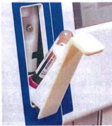
Рисунок 37. Выравнивание пробирки с пробой
