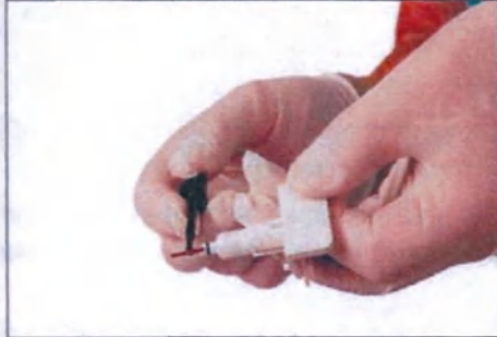
Рисунок 34. Установка микрокапилляра в МКА
